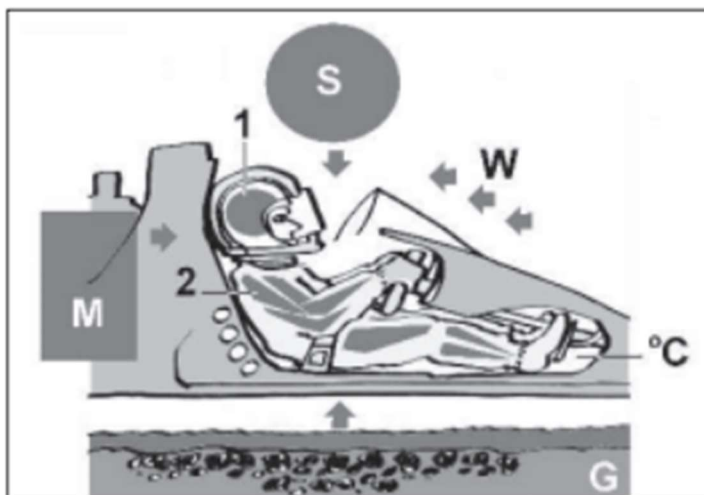
Fig. 1 – Diagrama do ambiente da cabina (cockpit) durante a corrida – Fontes externas de calor: S, solar; M, mecânica; G, do terreno; W, da massa de ar. Fontes internas de calor: 1, metabolismo cerebral; 2, atividade física muscular.
