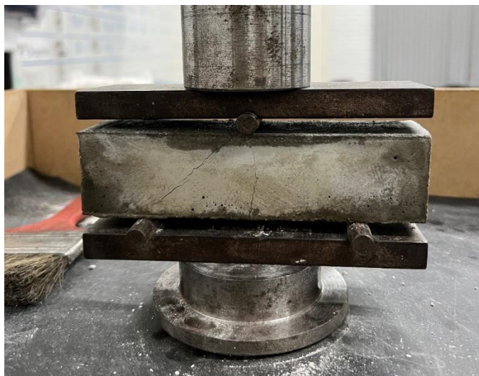
Figura 30 – Processo de fissuração dos corpos de prova
