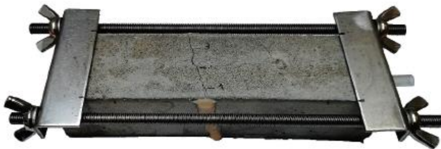
Figura 12 – Confinamento do corpo de prova utilizado por Van Mullem et al. (2020) para controle da espessura da fissura
