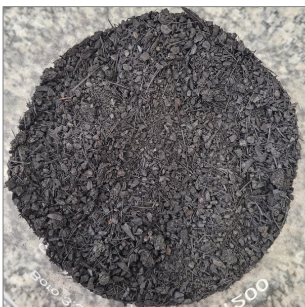
Figura 9 - Biocarvão produzido a partir de biomassa de babaçu via processo de pirólise lenta sob as condições de 350°C por 20 minutos
