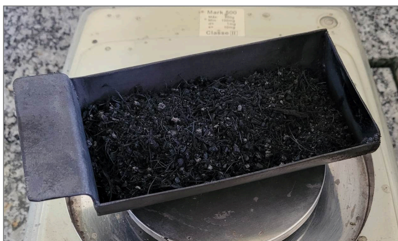
Figura 7 - Cadinho inserido no tubo do reator para a produção dos biocarvões de babaçu em menor escala
