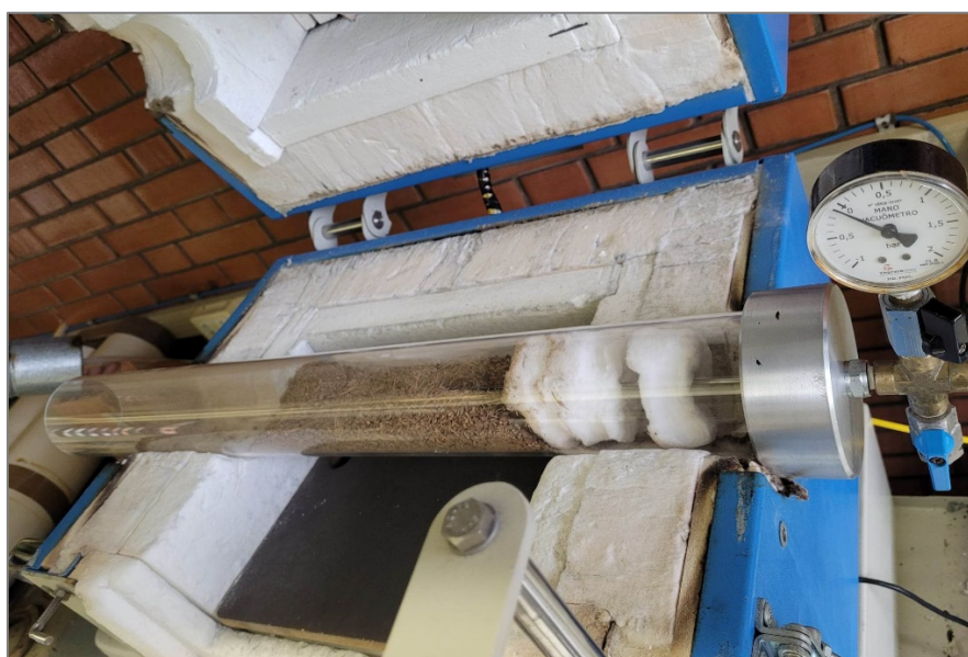
Figura 8 - Inserção da biomassa no tubo do reator para a produção do biocarvão de babaçu em maior escala
