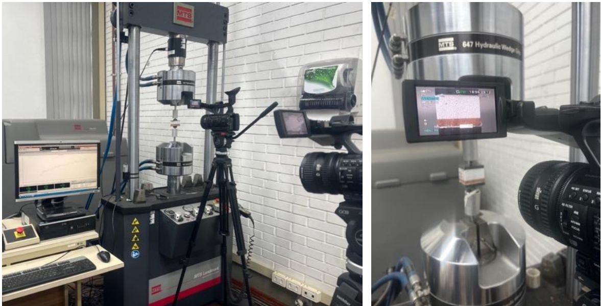
Figura 2 – Cenário do primeiro ensaio de resistência de aderência com aplicação da CID
