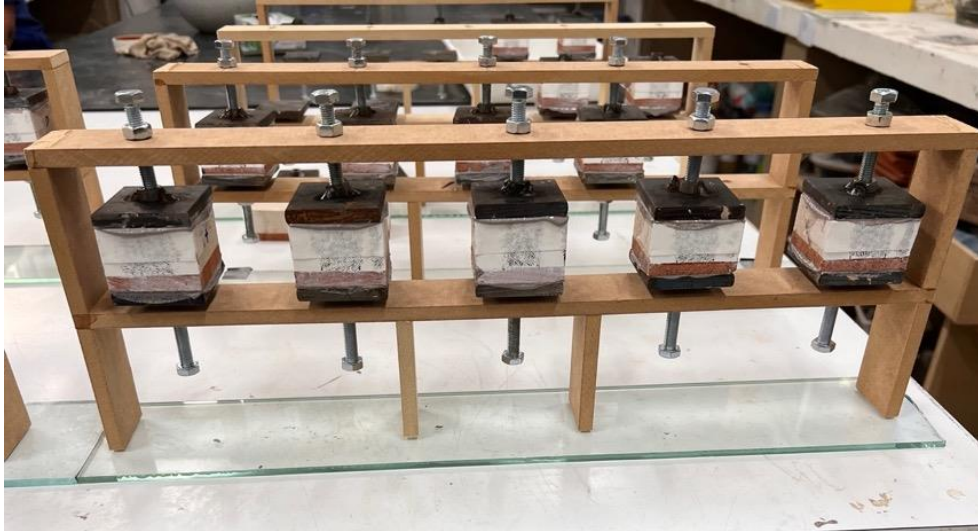
Figura 42 – Processo de colagem das pastilhas metálicas
