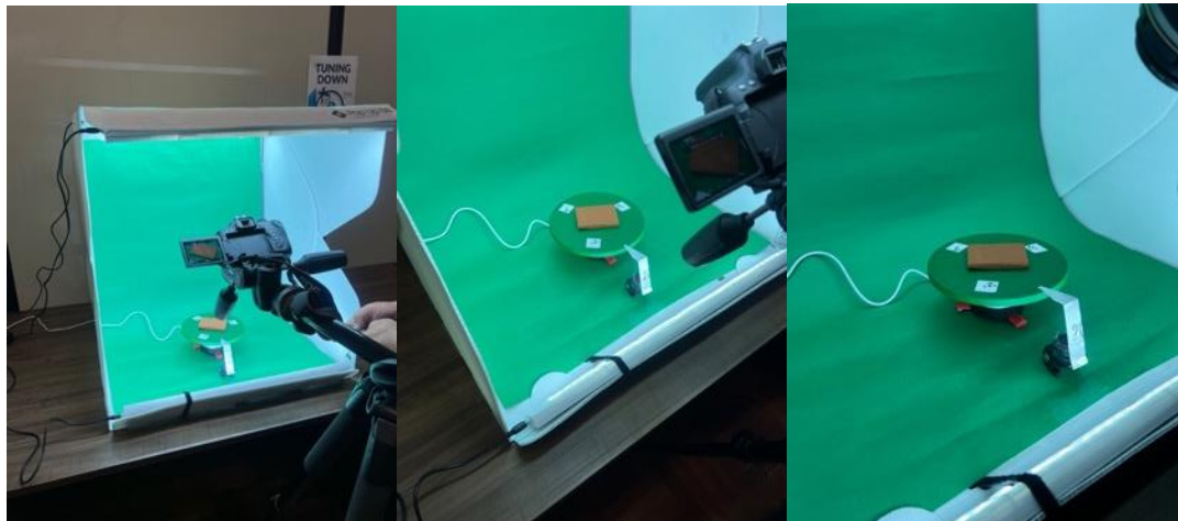
Figura 22 – Captura de imagens para o ensaio de rugosidade
