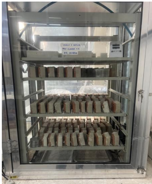
Figura 35 – Processo de sazonalamento das amostras
