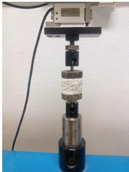
Figura 6 – Método de ensaio de resistência à tração direta
