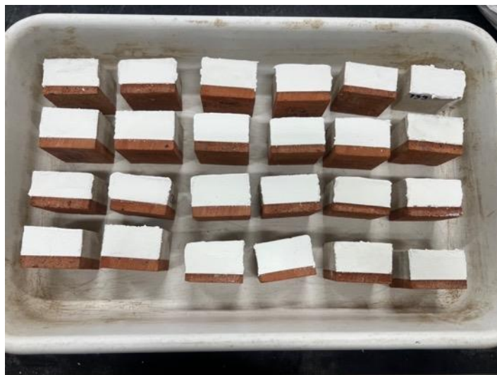
Figura 45 – Aplicação de camada de gesso sobre a superfície da argamassa
