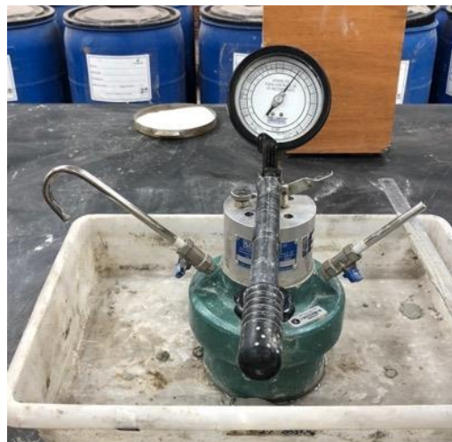
Figura 25 – Ensaio de teor de ar incorporado
