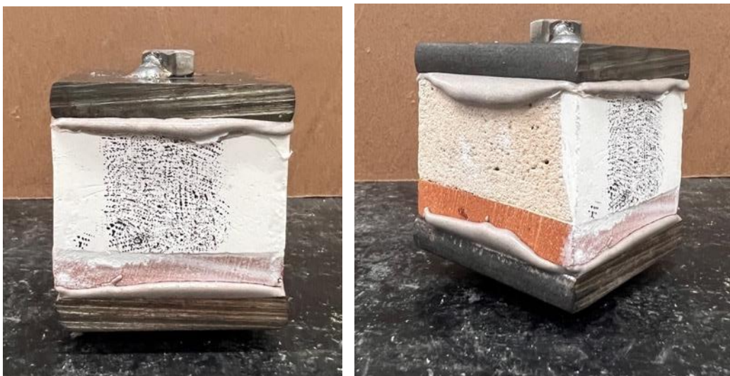
Figura 49 – Amostra finalizada para ensaio de resistência de aderência com aplicação do método CID
