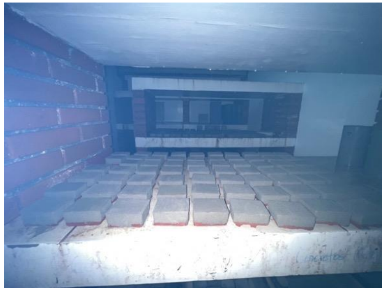
Figura 34 – Processo de cura dos revestimentos em câmara úmida
