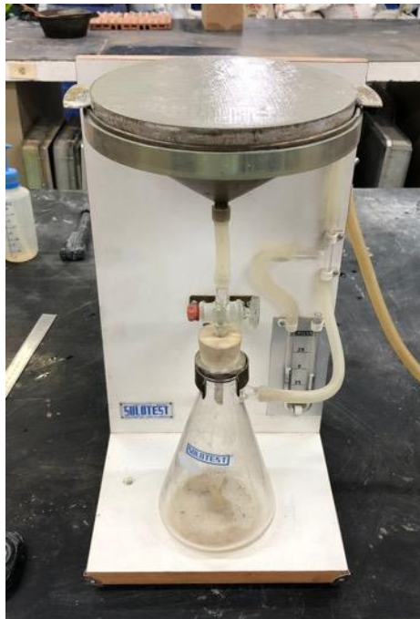
Figura 26 – Ensaio de retenção de água
