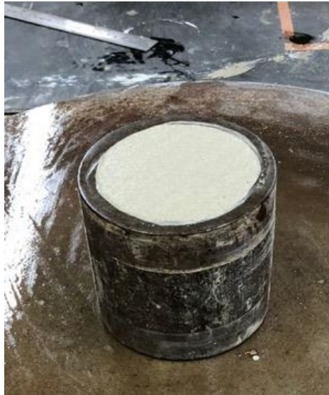
Figura 24 – Ensaio de densidade de massa
