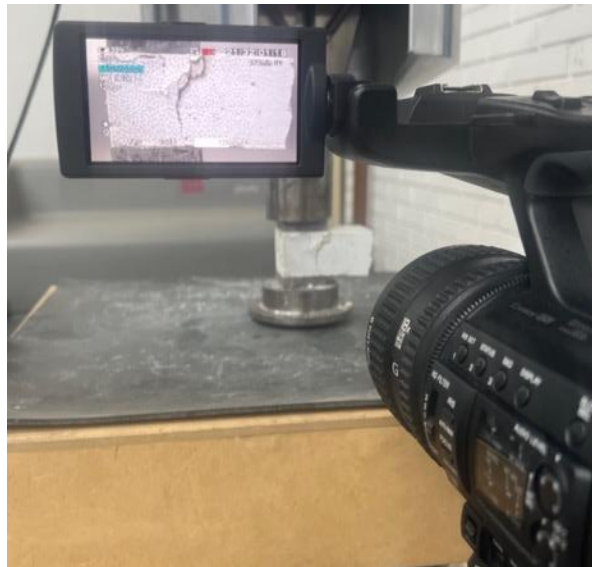
Figura 29 – Ensaio de resistência à compressão
