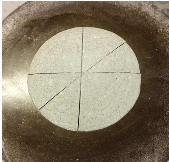
Figura 23 – Ensaio de índice de consistência
