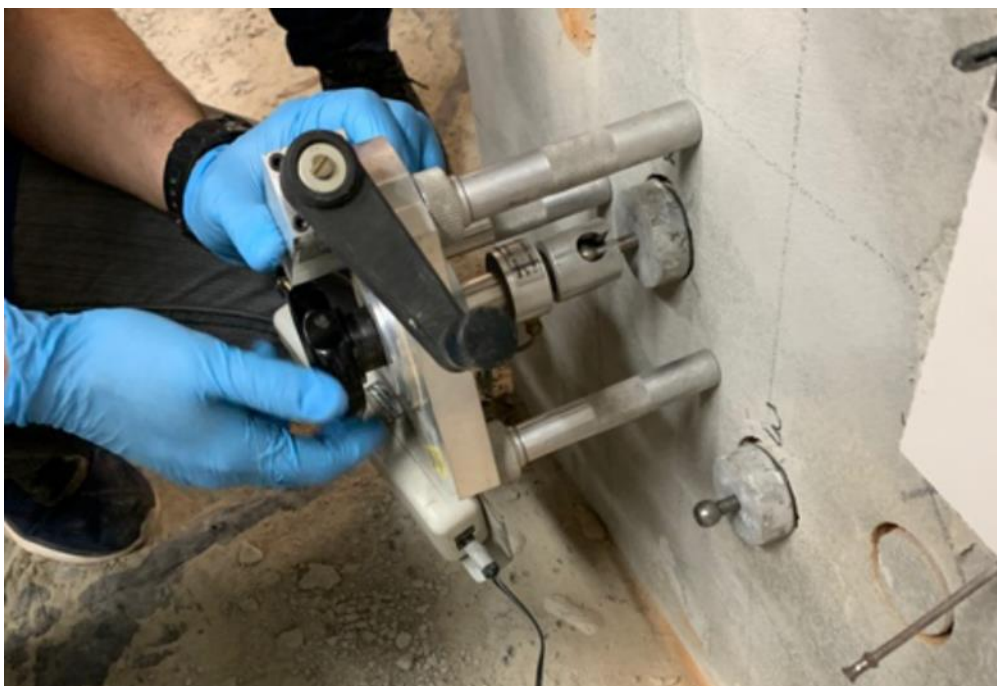
Figura 5 – Ensaio de resistência de aderência
