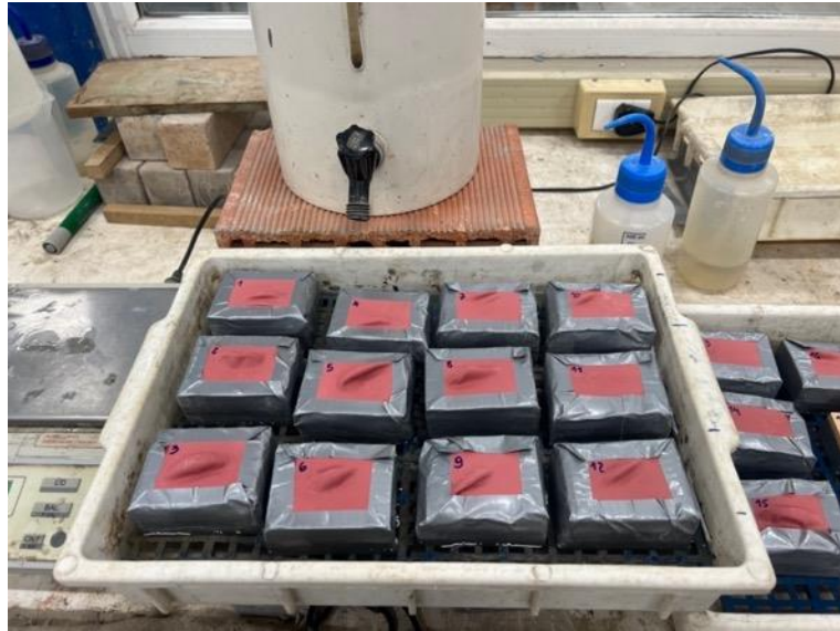
Figura 20 – Ensaio de absorção de água por capilaridade
