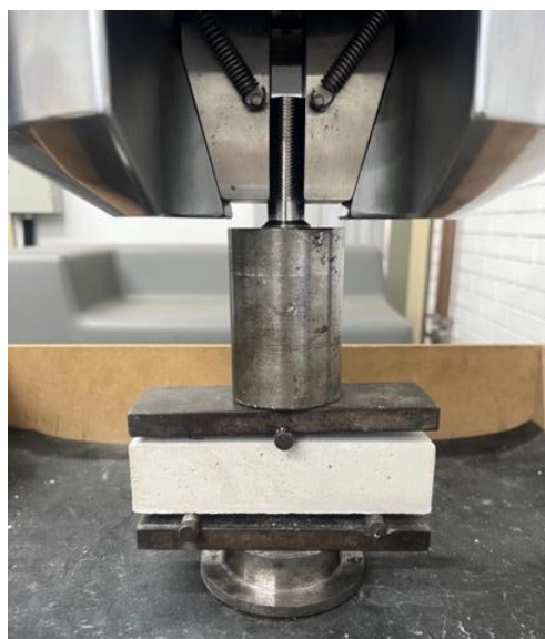
Figura 28 – Ensaio de resistência à tração na flexão
