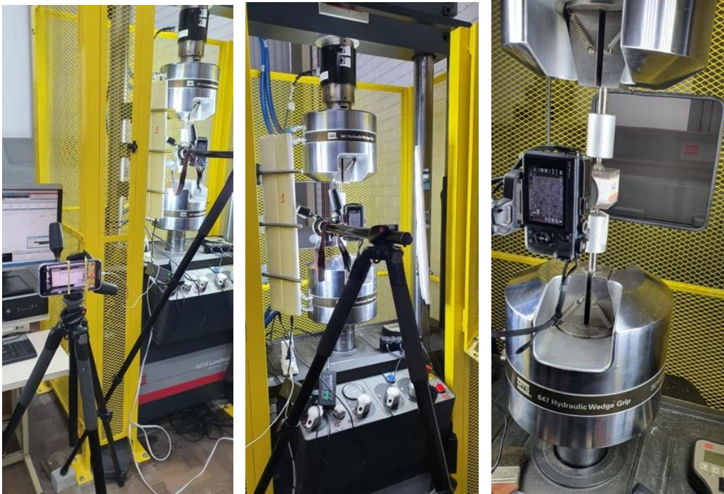
Figura 48 – Cenário para ensaio de resistência de aderência com aplicação do método CID após reajustes
