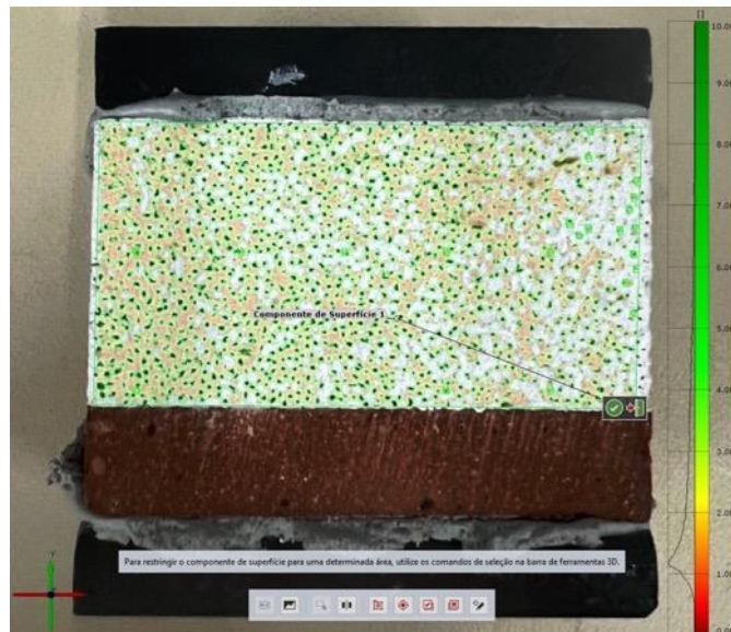
Figura 5 – Qualidade da malha do primeiro ensaio de resistência de aderência com aplicação do método CID
