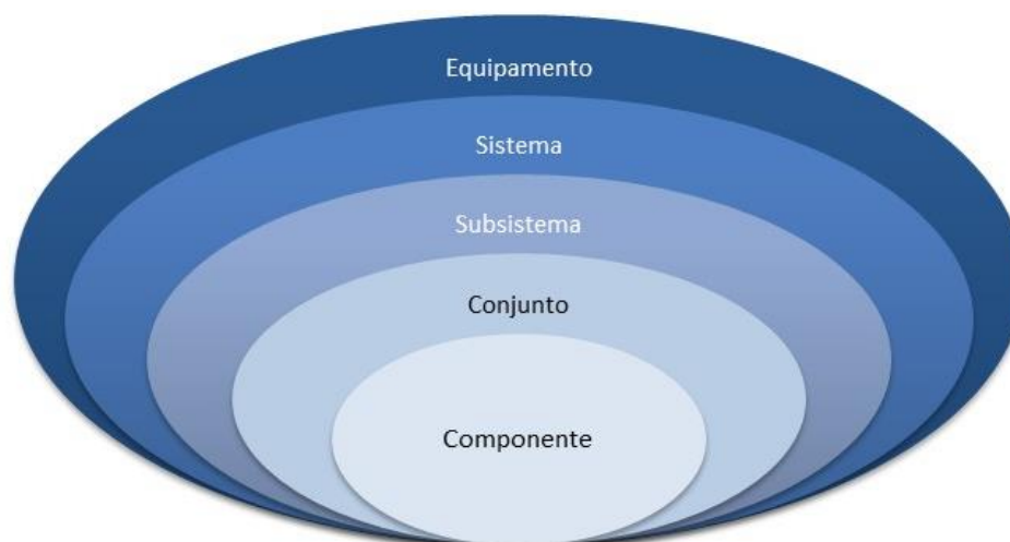
Figura 6 – Esquema da divisão do equipamento na matriz FMEA
