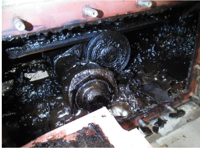
Fotografia 5 – Presença de Polímero Pré-Sinter
