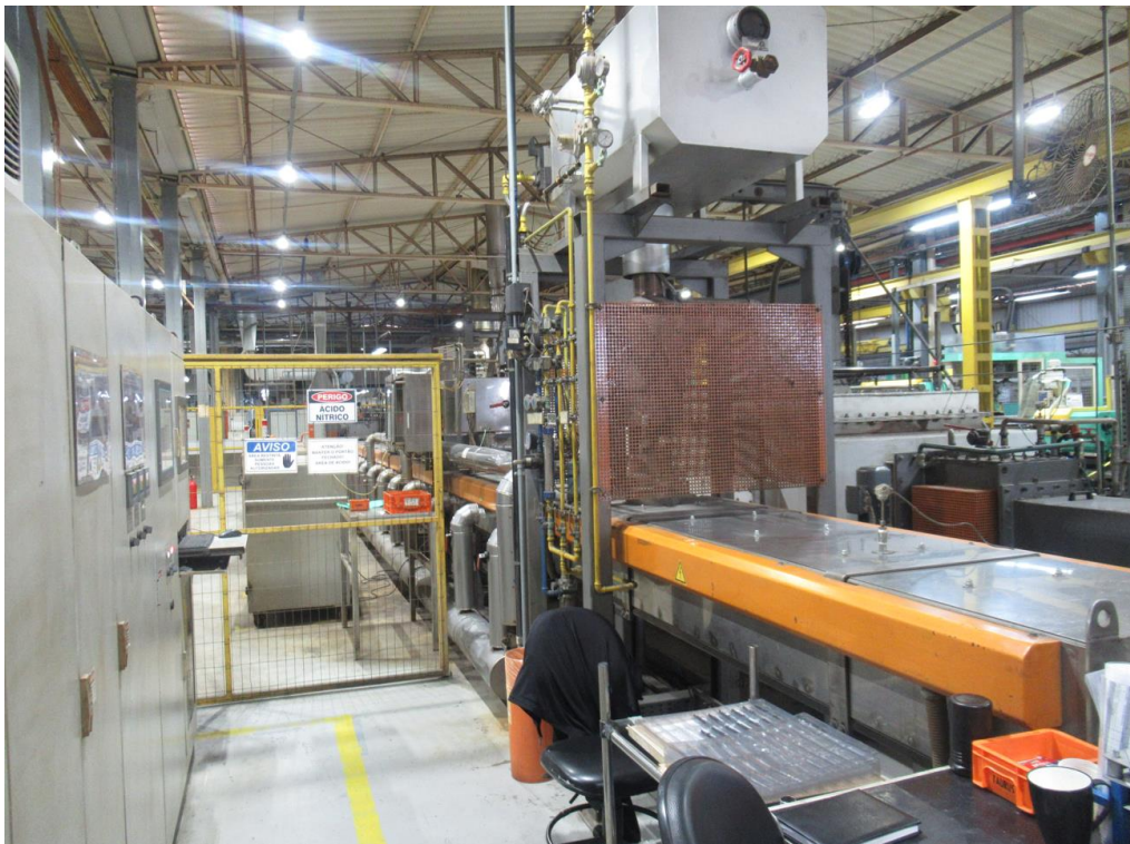
Fotografia 1 – Exemplo de Forno de Sinterização Contínua
