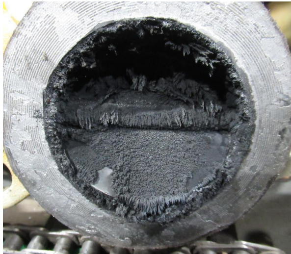
Fotografia 9 – Obstrução parcial de Polímero Throttle Valve
