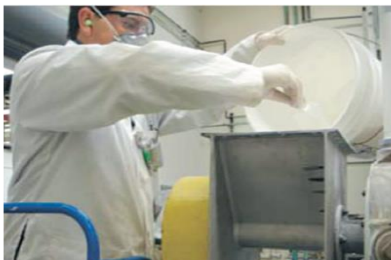
Figura 22: Trabalhador envolvido na produção de nanopartículas, durante uma operação de fundição com dispositivos para proteção auditiva, respiratória e dérmica.
