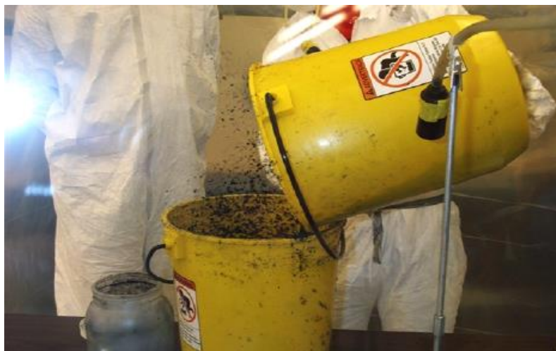
Figura 21: Amostragem de ar durante o manuseio de nanotubos de carbono bruto.
