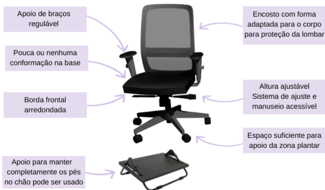
Figura 3: Pontos indicados pela NR-17 para cadeira
