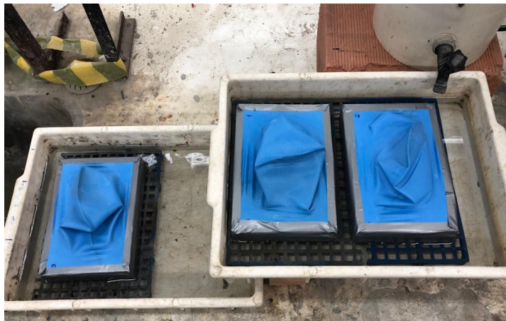
Fotografia 2 – Ensaio de absorção de água por capilaridade nos blocos
