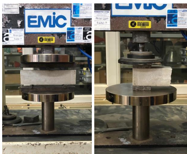
a) Tração na flexão; b) Compressão;
