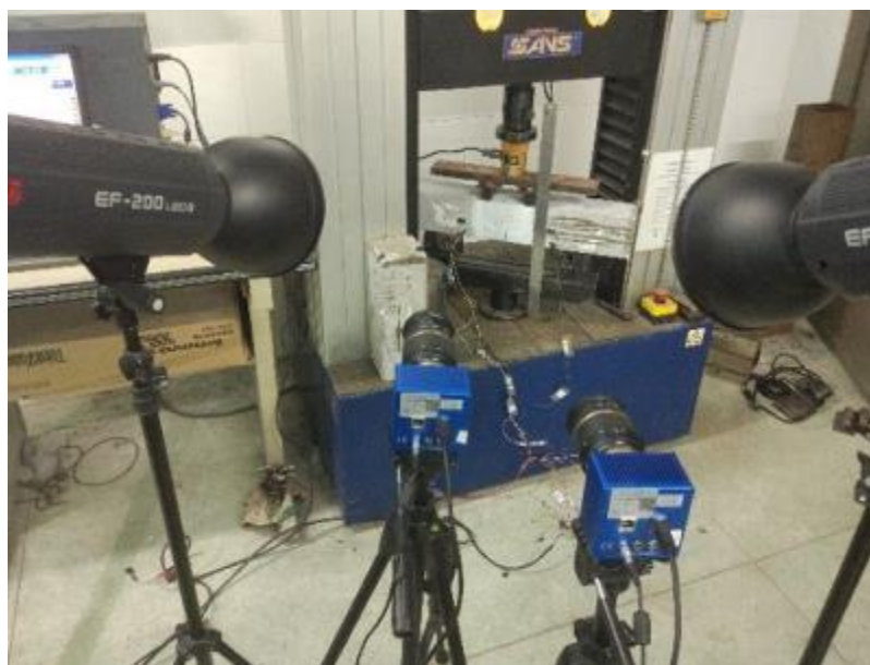
Figura 11 – Posicionamento da amostra, câmeras e luzes para o ensaio de DIC
