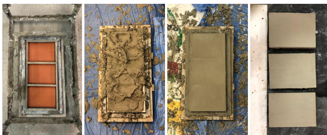
Fotografia 11 – Execução da moldagem dos revestimentos
