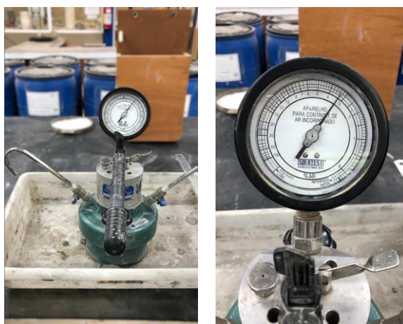
a) Equipamento de medição vedado; b) Registro do teor de ar incorporado;
