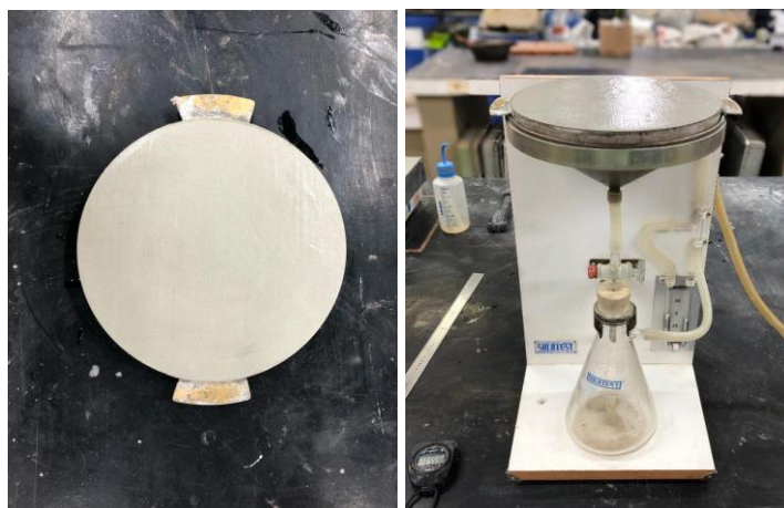
a) Prato com argamassa; b) Ensaio do conjunto;
