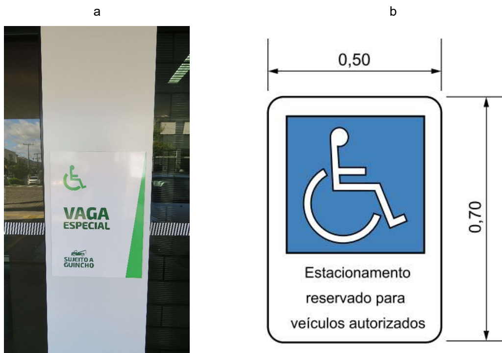
Figura 45 - Sinalização vertical de identificação de vaga para pessoas com deficiência
