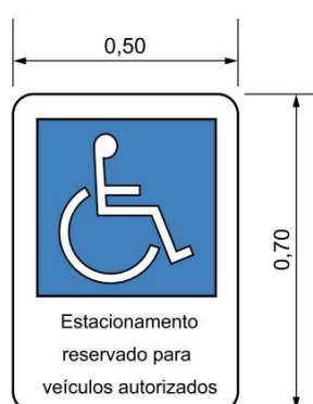
Figura 13 - Sinalização vertical para vagas reservadas às PCD
