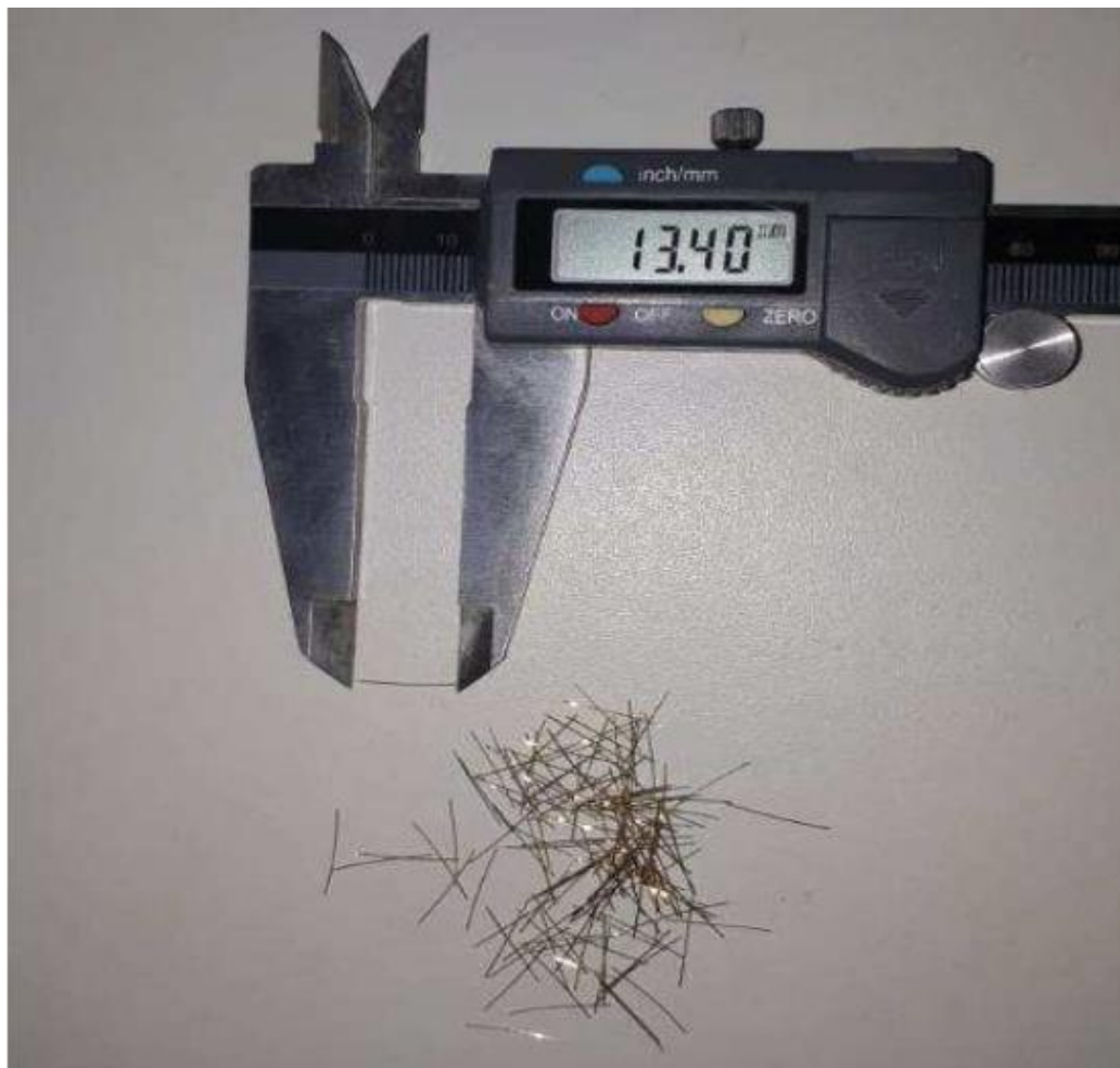
Figura 24 – Fibra de aço aplicada nas misturas da pesquisa.
