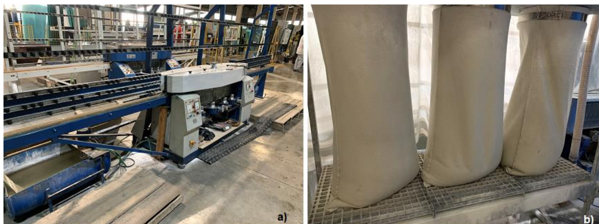
Figura 23 – Máquina de desbastamento (a) e coleta do resíduo de vidro (b)
