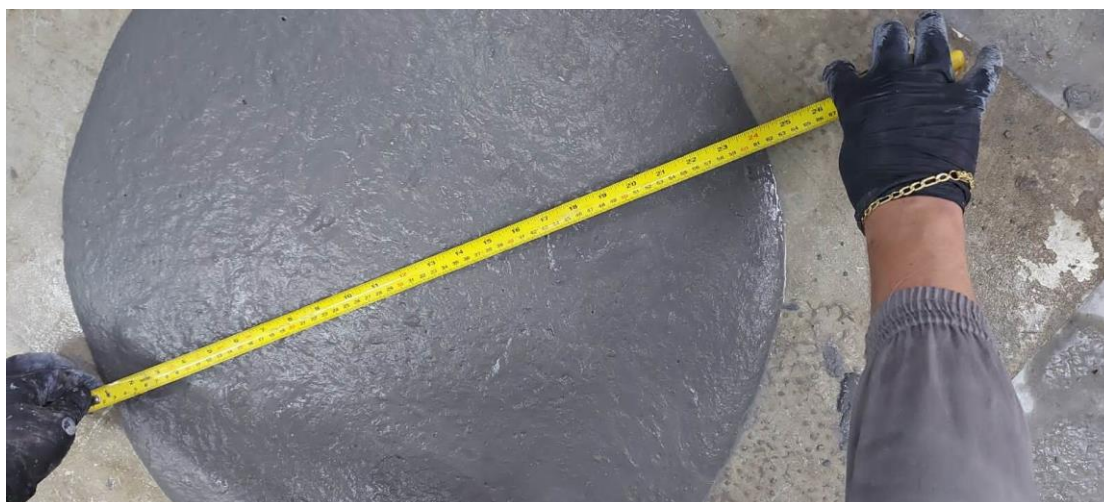
Figura 31 – Espalhamento de mistura de UHPC
