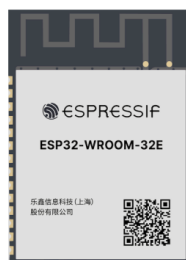
Figura 26 – Modulo ESP-32-WROOM-32 com Wi-Fi integrado.
