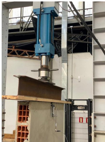
Figura 57 – Sistema de carregamento e distribuição de carga
