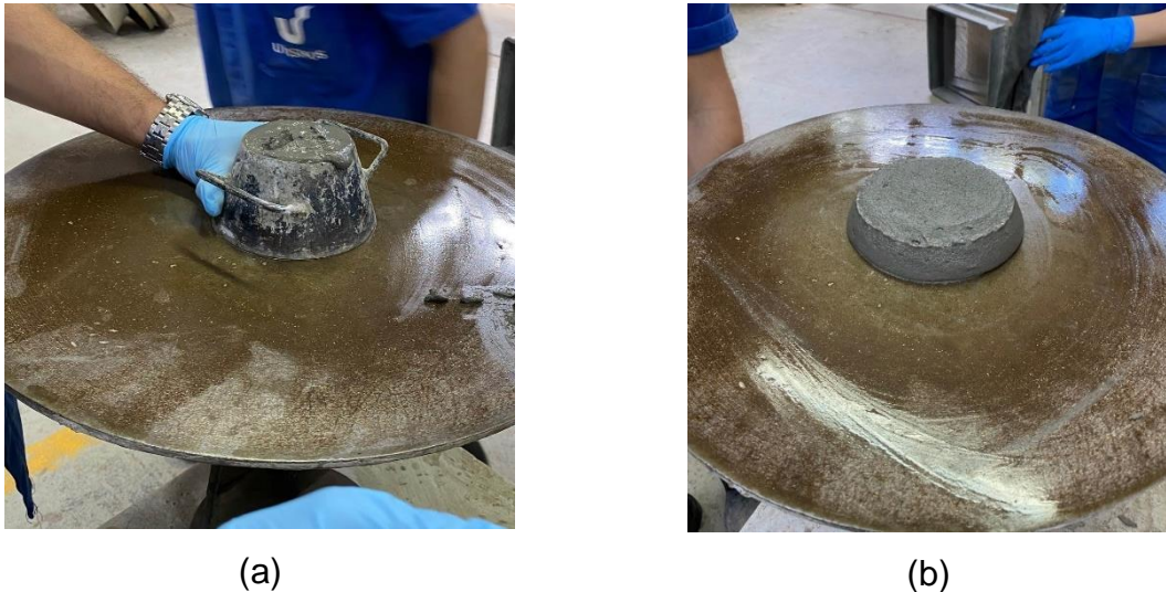
Figura 42 – Ensaio de índice de consistência
