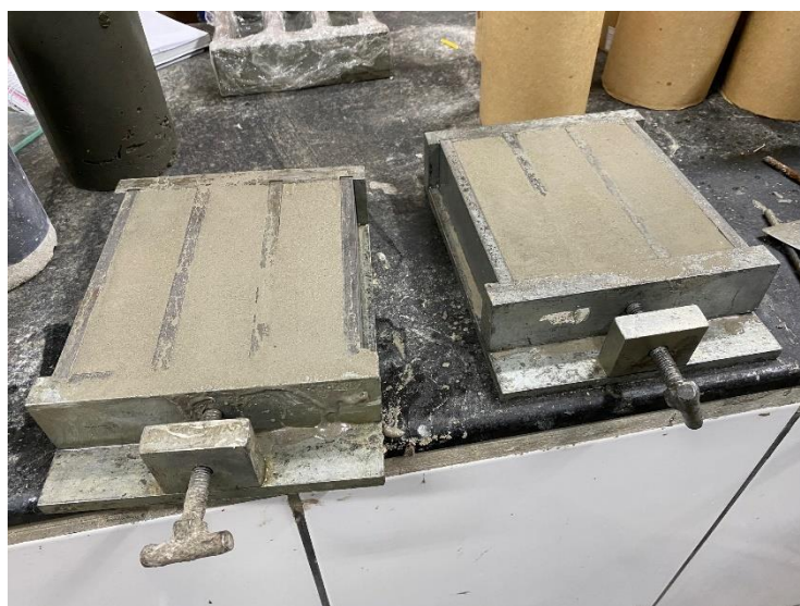
Figura 36 – Moldagem dos corpos de prova
