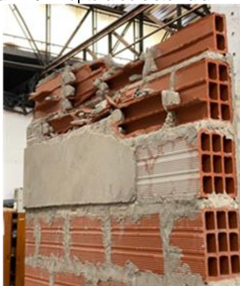
Figura 72 – Parede P2E-a1:1:6 - Ruptura do sistema a 144,92kN
