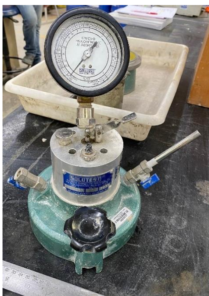
Figura 39 – Aparelho de controle de ar incorporado
