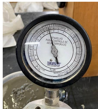
Figura 41 – Introdução de ar na válvula principal do equipamento
