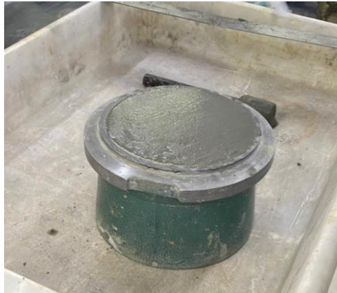
Figura 40 – Preenchimento com argamassa a base cilíndrica
