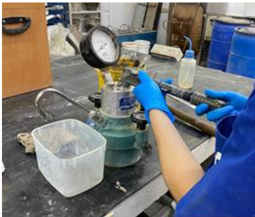
Figura 41 – Introdução de ar na válvula principal do equipamento
