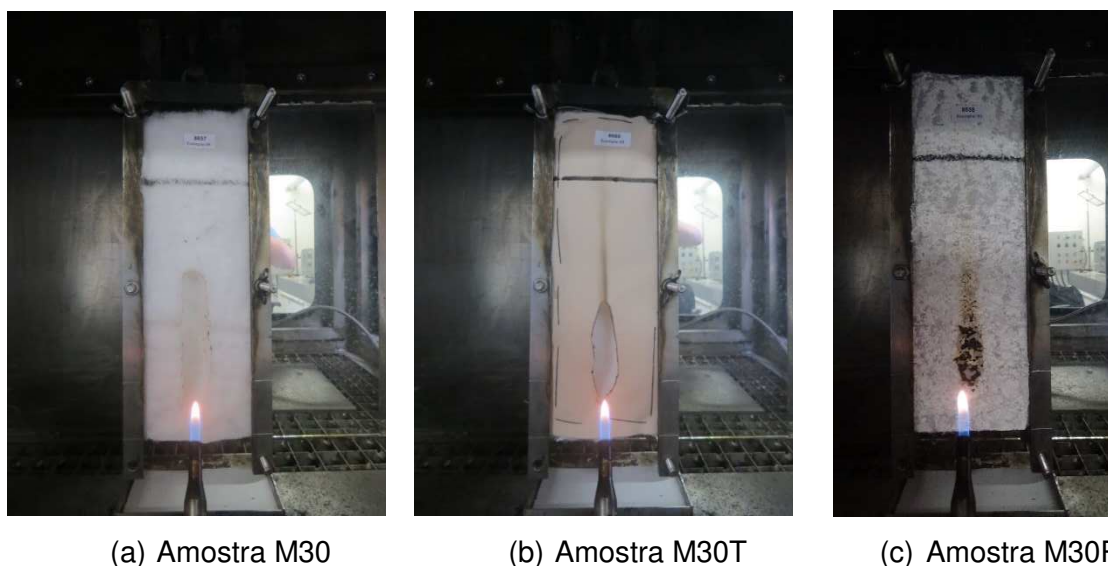
Figura 16 - Amostras de densidade aparente 30 \text{ kg/m}^3 , após ensaio de ignitabilidade
