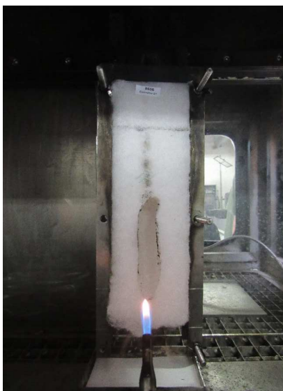
Figura 13 - Amostra colocada no equipamento de ensaio de ignitabilidade
