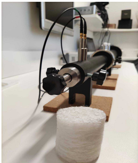
Figura 11 - Amostra para ensaio de tubo de impedância
