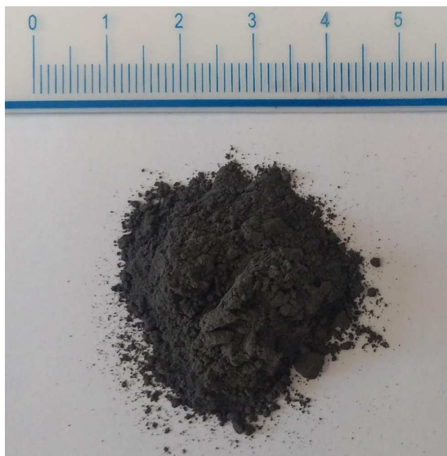
Fotografia 6 - Amostra de ímã moído e peneirado <0,25mm
