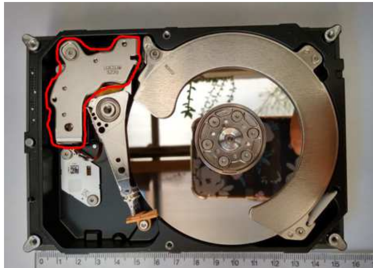
Fotografia 1 - Localização do ímã em um HD de computador indicada pela região destacada em vermelho
