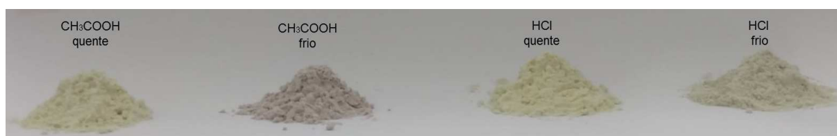
Fotografia 10 - Precipitados secos durante 24h a 60°C
