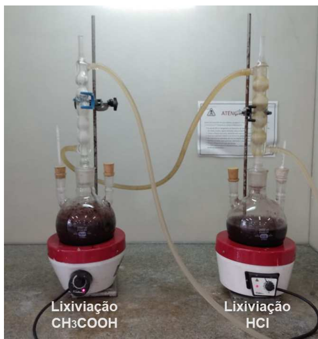
Fotografia 4 - Sistema utilizado nos processos de lixiviação à quente
