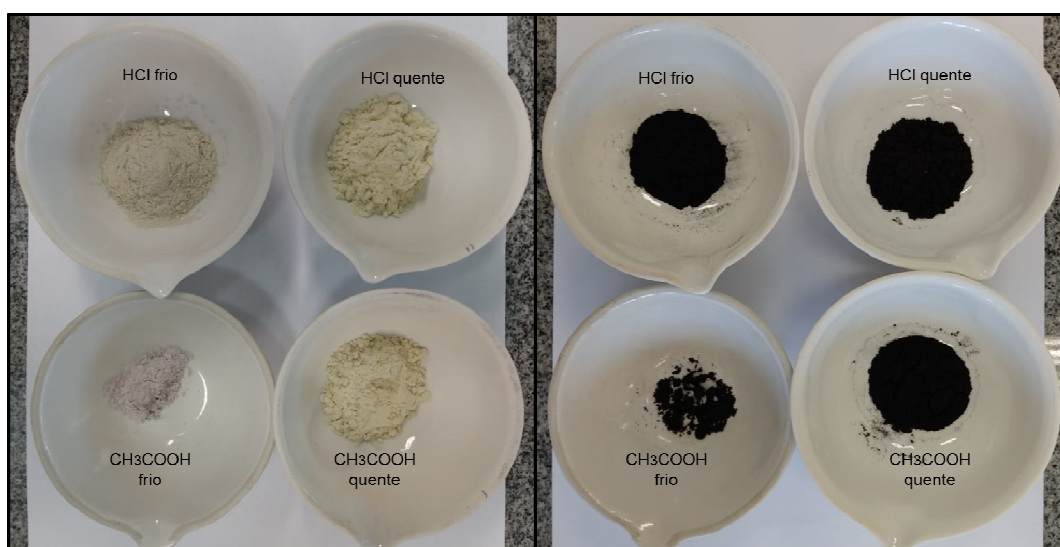
Fotografia 11 - Pré roasting versus pós roasting do oxalato de Nd
