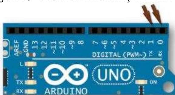
Figura 13 - Portas de comunicação serial RX/TX
