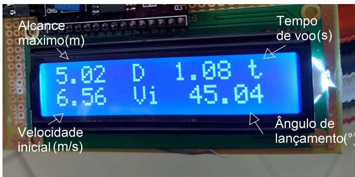
Figura 6 – Vista frontal do LCD com as respectivas posições das informações
