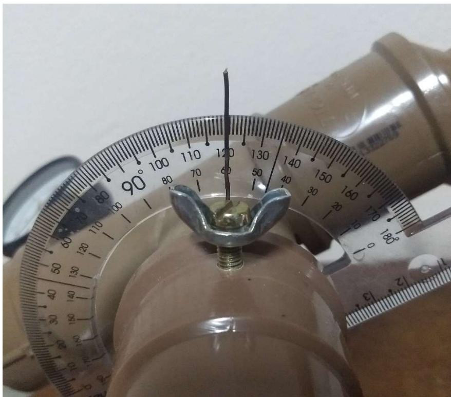
Figura 4 – Posicionamento do ponteiro em relação ao transferidor para o correspondente ângulo de lançamento de 30°
