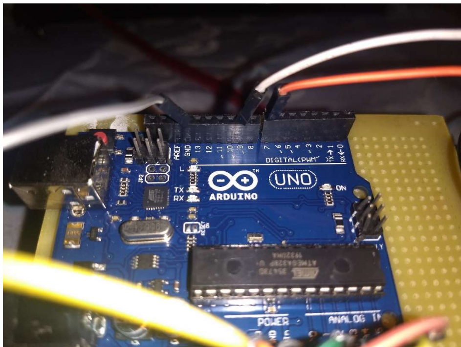
Figura 26 – Ligações: do potenciômetro ao GND; dos sensores aos pinos digitais;
