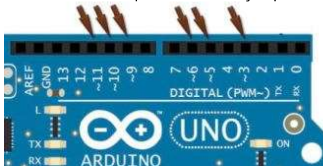
Figura 12 - Portas PWM possuem indicação pelo acento til
