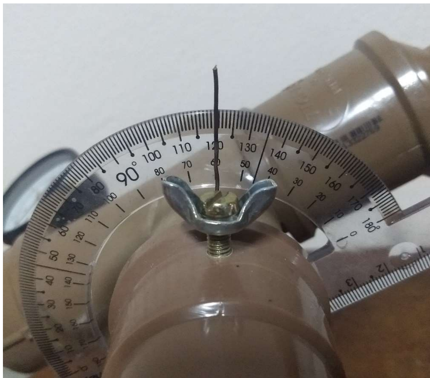
Figura 4 – Posicionamento do ponteiro em relação ao transferidor para o correspondente ângulo de lançamento de 30^\circ
