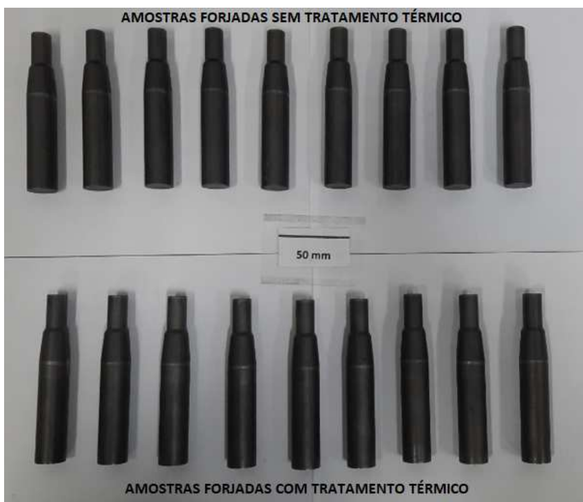
Figura 73 - Amostras forjadas a frio (em cima amostras sem ToTo, abaixo amostras forjadas com ToTo).
