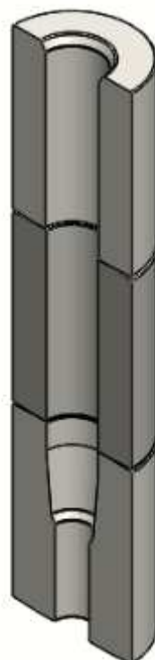
Figura 53 - Modelamento tridimensional da matriz em Solidworks 2019
