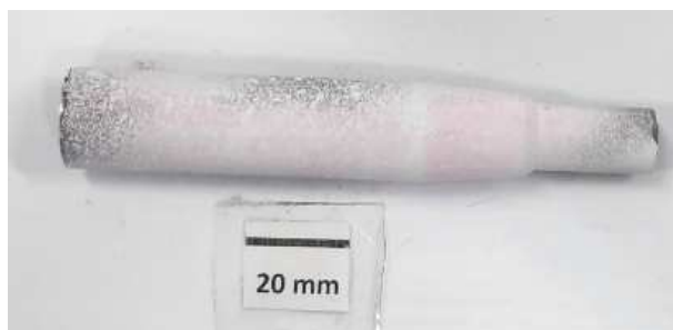
Figura 72 - Ensaio não destrutivo de líquido penetrante (Amostra com ToTo)
