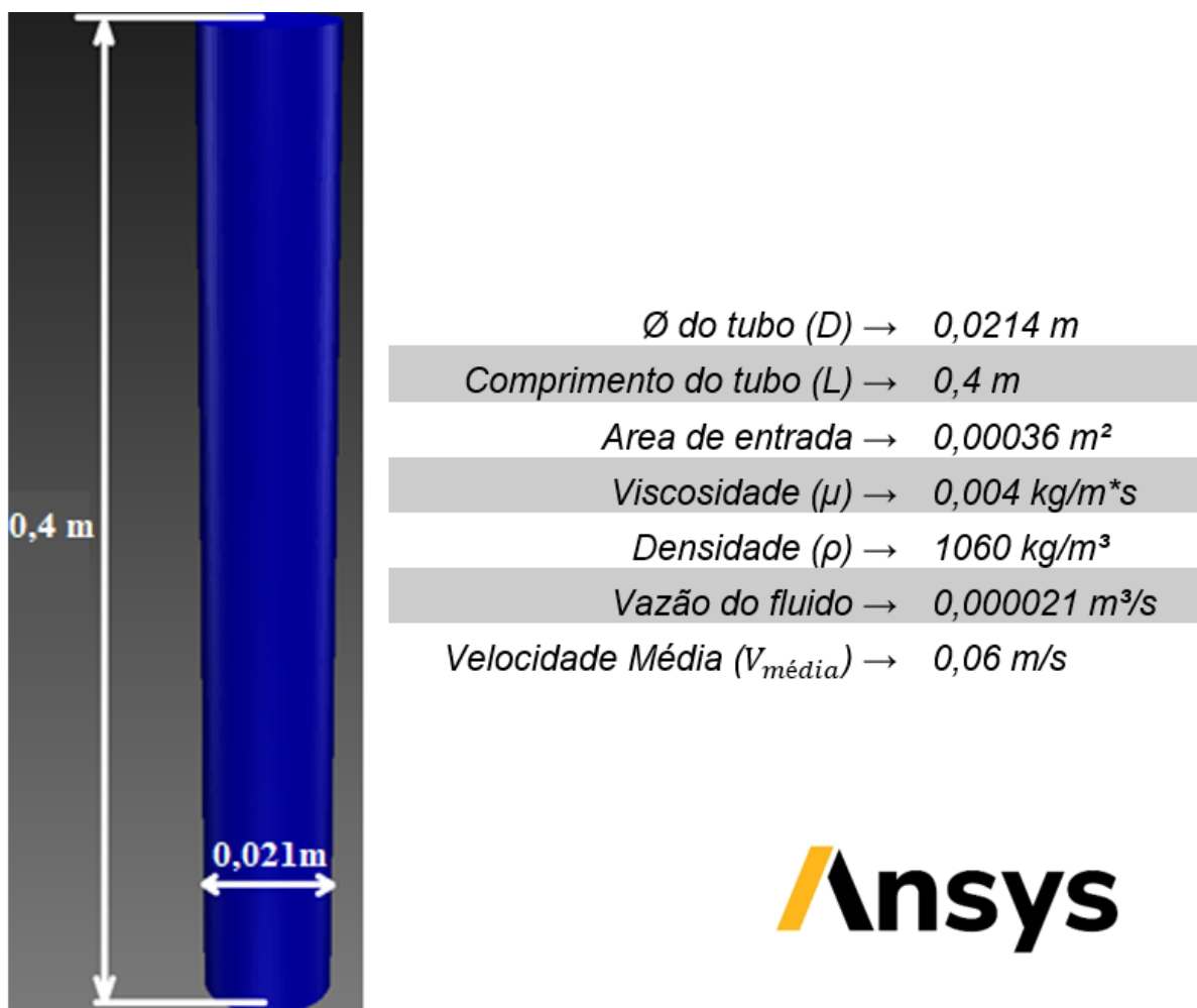
Figura 27 - Condições de contorno do tubo.
