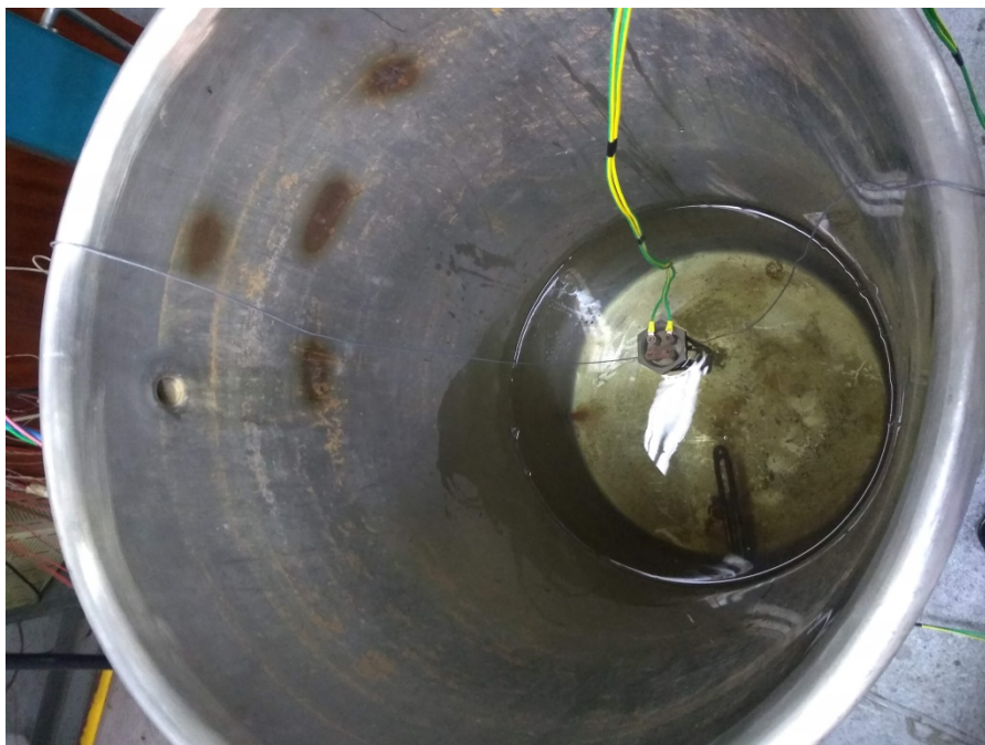
Figura 16. Tanque e resistências utilizados no umidificador.
