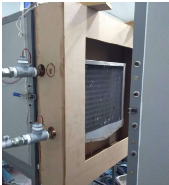
Figura 15. Instalação do trocador de calor no túnel de vento.
