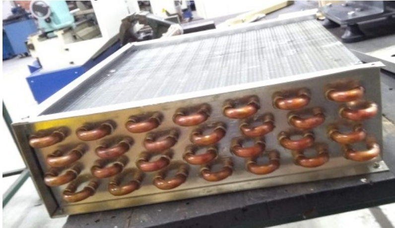
Figura 12. Trocador de calor utilizado.
