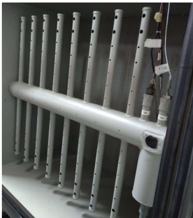
Figura 7. Coletor de ar para medidas de temperatura.
