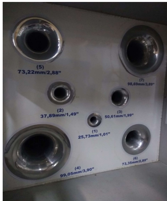
Figura 8. Placa de bocais no túnel de vento.
