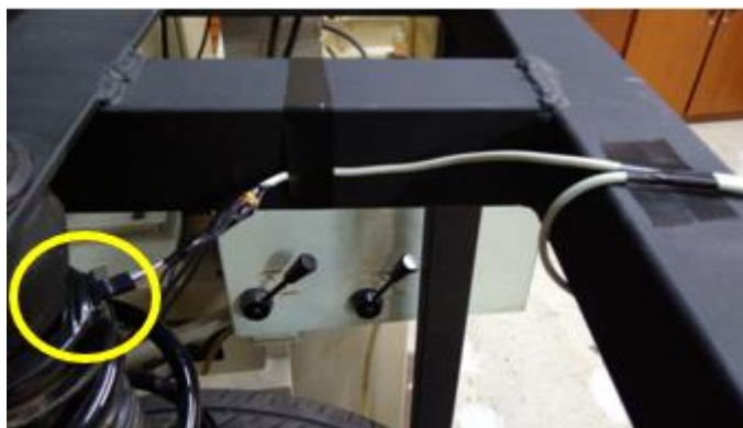
Figura 34 – Fixação do acelerômetro na parte superior da suspensão
