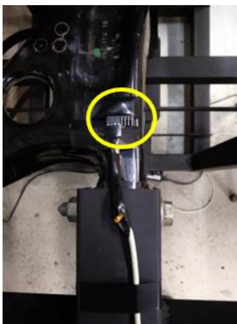
Figura 35 – Fixação do acelerômetro na bandeja de suspensão
