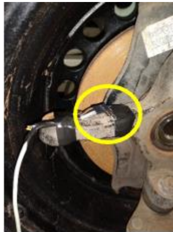
Figura 33 – Fixação do acelerômetro no suporte do cubo da roda
