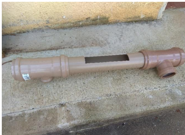
Figura 25: Montagem da calha em tubo PVC
