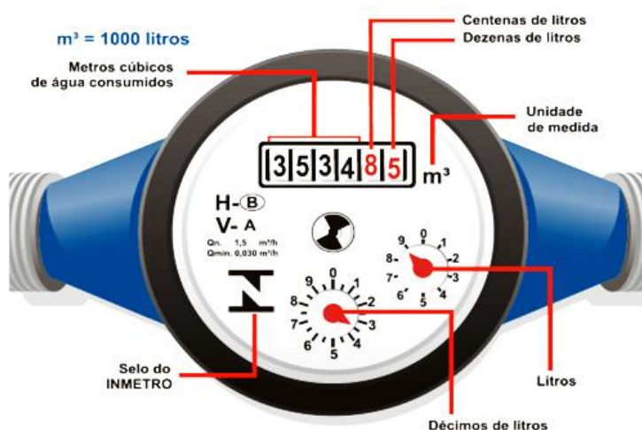
Figura 15: Cúpula de leitura do hidrômetro
