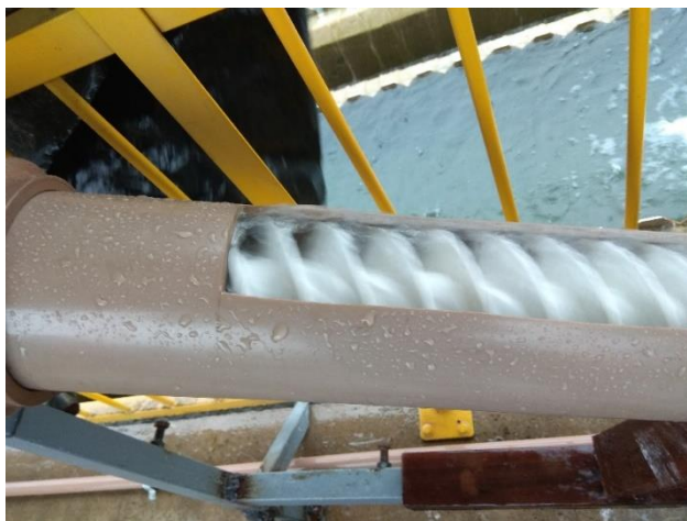
Figura 33: Turbina operando com 1,41 l/s
