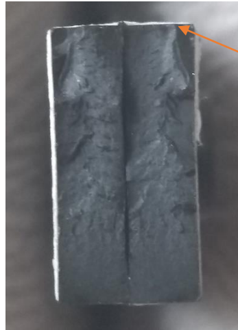
Figura 32 – Fratura do corpo de prova 8 de ABS1%OG.
