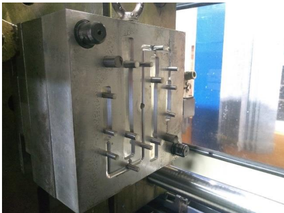
Figura 22 – Fixação do molde de injeção.
