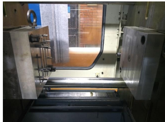
Figura 22 – Fixação do molde de injeção.
