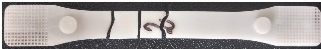
Figura 28 – Fratura frágil do corpo de prova 2 de ABS.
