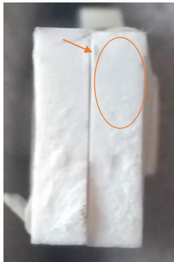
Figura 30 – Fratura do corpo de prova 6 de ABS.
