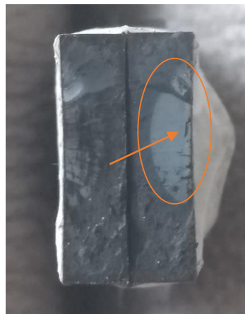
Figura 33 – Fratura do corpo de prova 6 de ABS1%OC.
