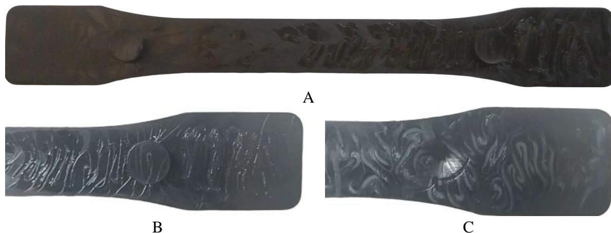
Figura 26 – Defeitos superficiais na seção transversal do corpo de prova.
