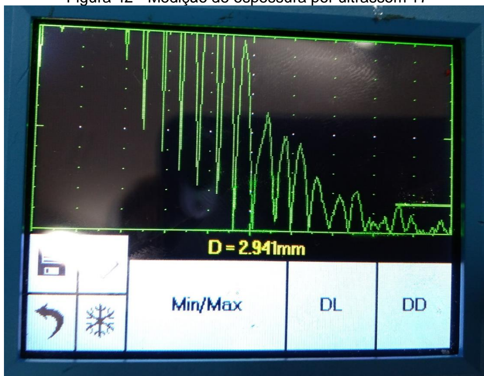
Figura 42 - Medição de espessura por ultrassom 17
