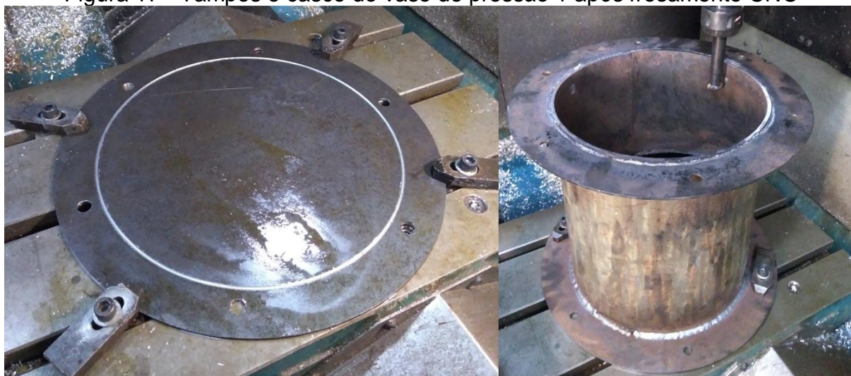
Figura 17 - Tampos e casco do vaso de pressão 1 após fresamento CNC
