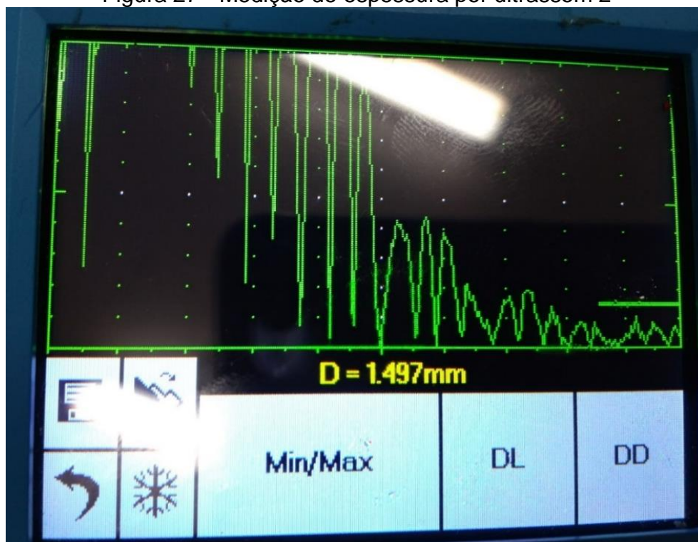
Figura 27 - Medição de espessura por ultrassom 2
