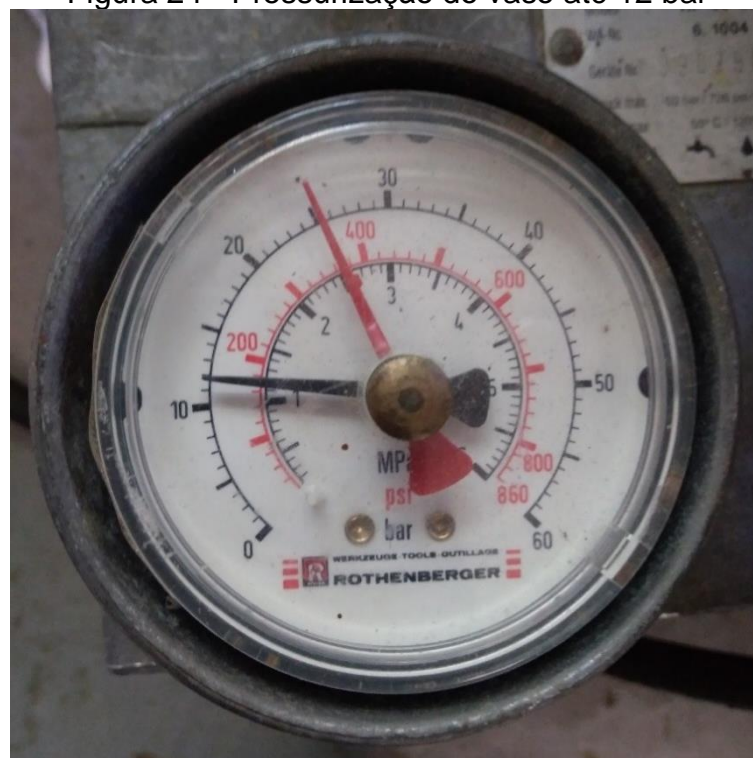
Figura 24 - Pressurização do vaso até 12 bar
