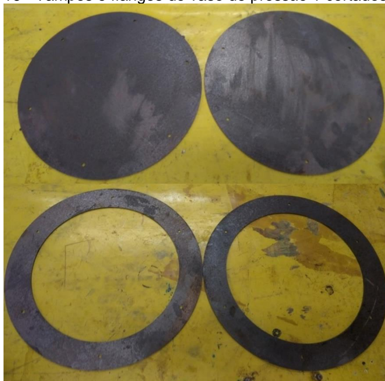
Figura 16 - Tampos e flanges do vaso de pressão 1 cortados a laser
