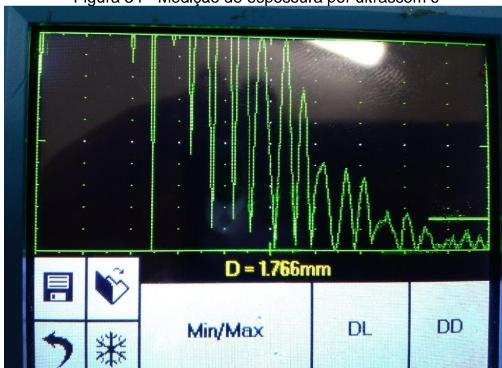
Figura 34 - Medição de espessura por ultrassom 9
