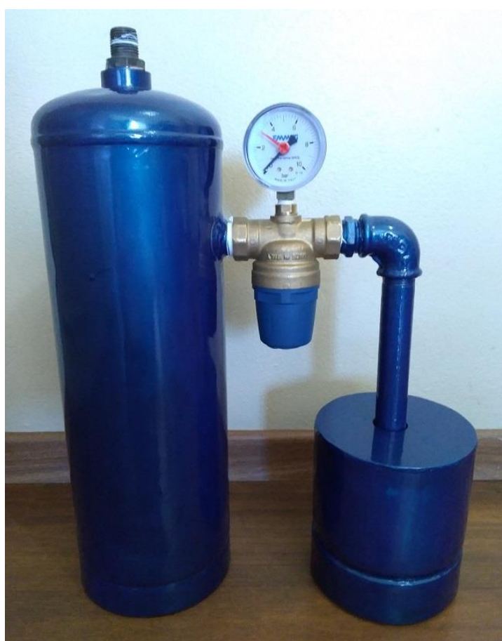
Figura 19 - Vaso de pressão 2 montado
