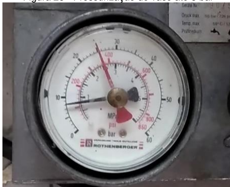
Figura 23 - Pressurização do vaso até 8 bar
