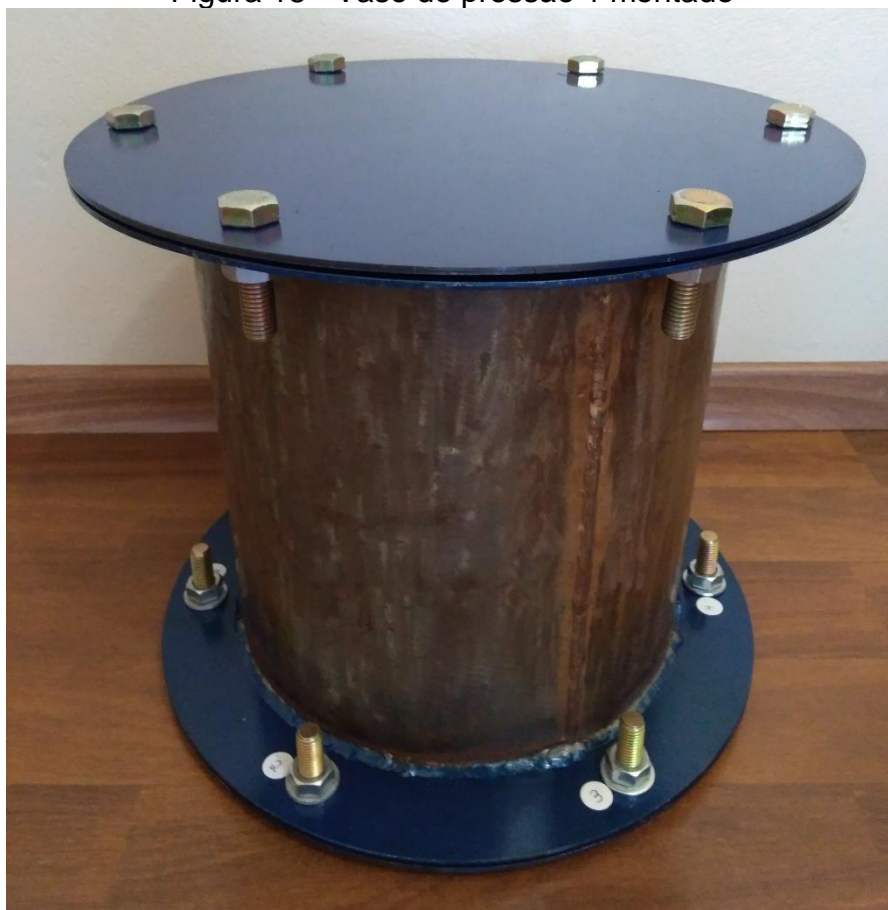
Figura 18 - Vaso de pressão 1 montado
