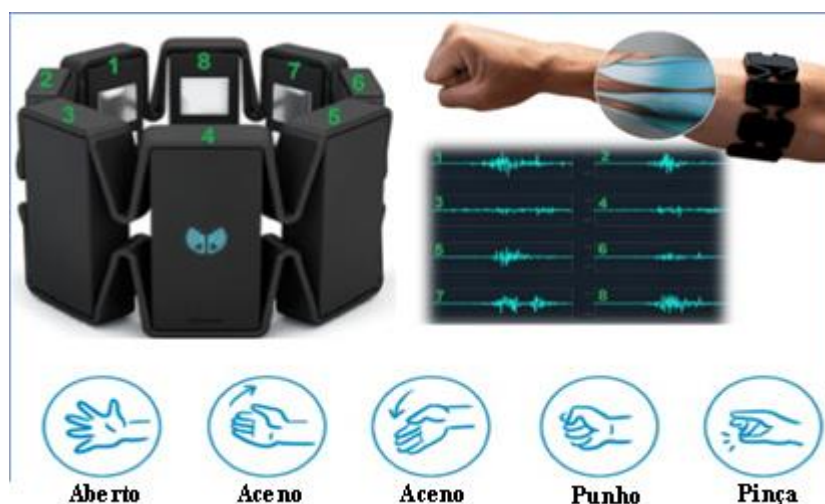
Figura 10: Demonstração da Thalmic Myo Armband, com seus 8 canais de captura e movimentos que garante identificar.
