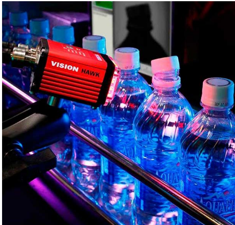
Figura 2 - Sistema de inspeção visual contribuindo no setor de qualidade
