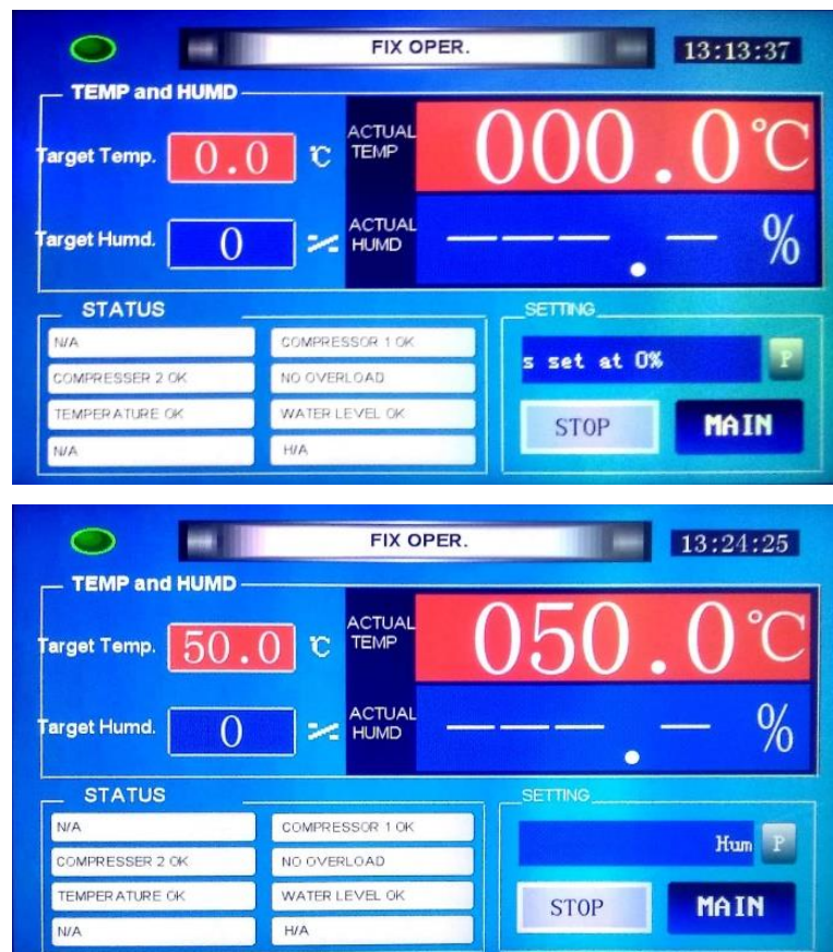
Figura 70 – Ajustes de temperatura na câmara térmica
