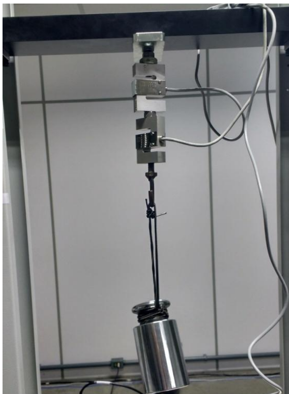
Figura 48 – Máquina com peso padrão de 5 kg
