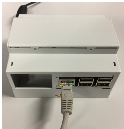
Figura 9 - Raspberry PI instalada em uma caixa
