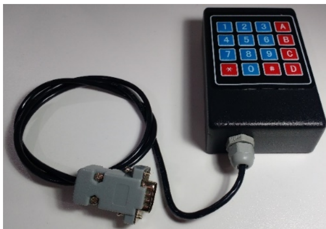
Figura 45 - Módulo leitor de teclado montado
