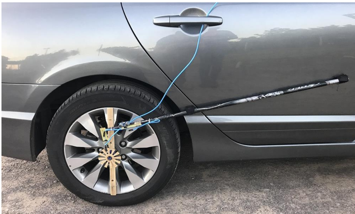
Figura 26 – Suporte do sensor de deslocamento e sensor de distância lateral
