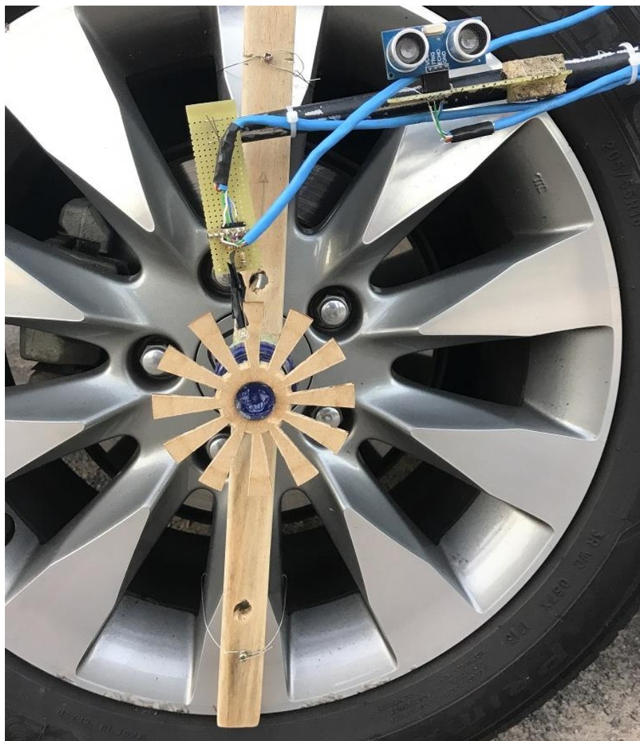
Figura 25 – Sensor de deslocamento e sensor de distância lateral
