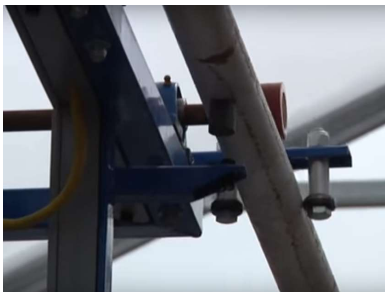
Figura 5 - Ímãs ao longo do trilho utilizados pelo controlador da Zwart
