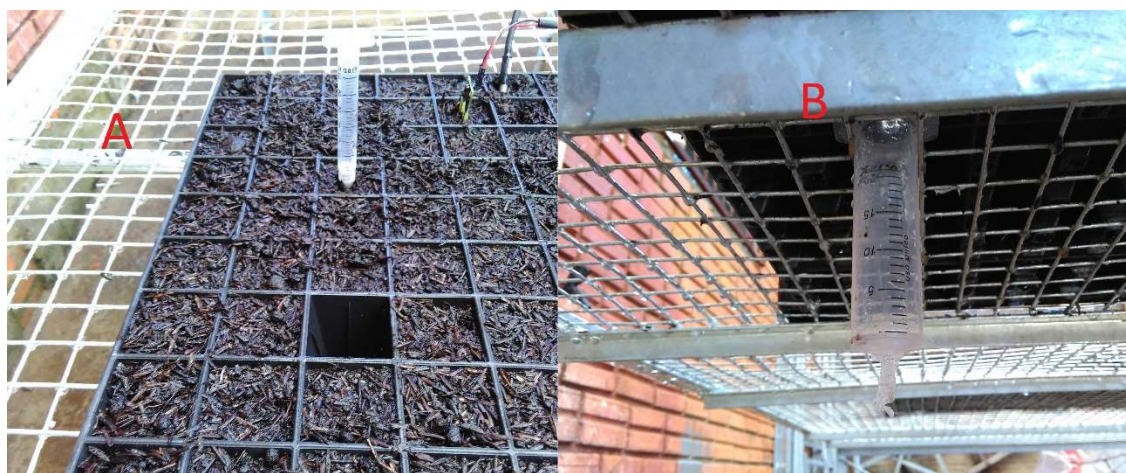
Figura 69 - Procedimento para coleta do volume de água: a) Célula vazia; b) Recipiente de coleta.
