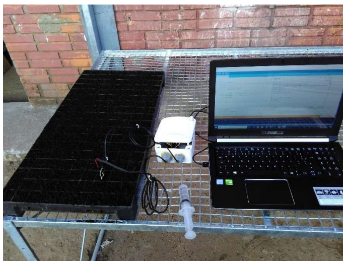
Figura 45 - Procedimento de leitura do ADC do Wemos
