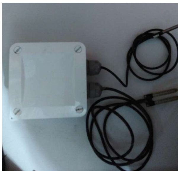
Figura 52 - Conjunto sensor acomodado em caixa à prova d'água
