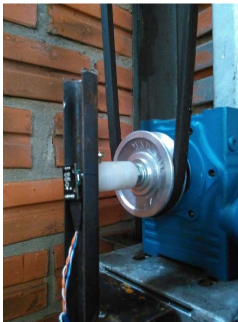
Figura 63 - Acoplamento e fixação do encoder
