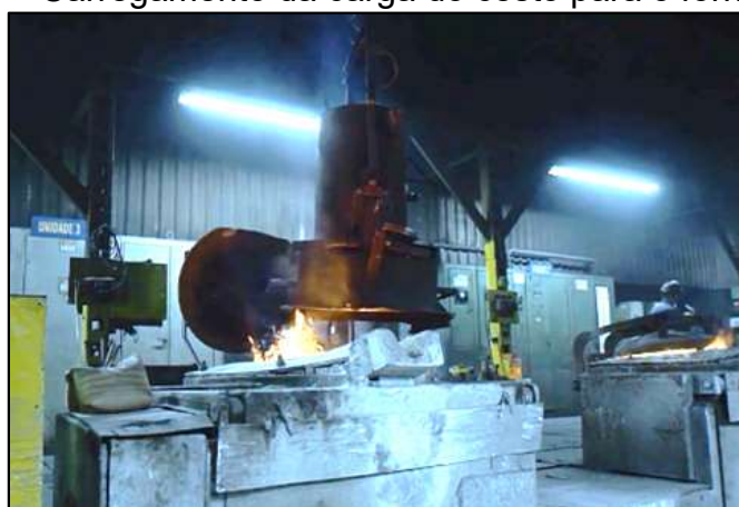
Figura 31 – Carregamento da carga do cesto para o forno de fusão
