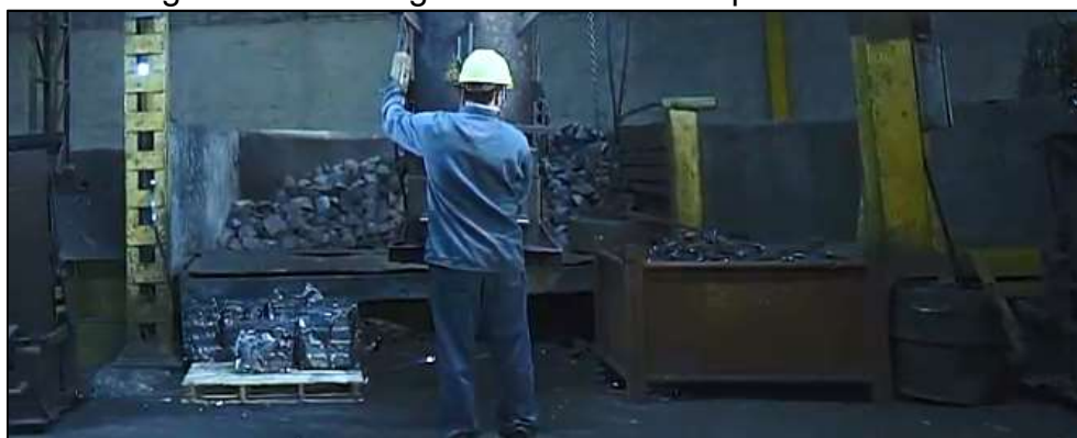
Figura 30 – Carregamento de matéria prima no cesto
