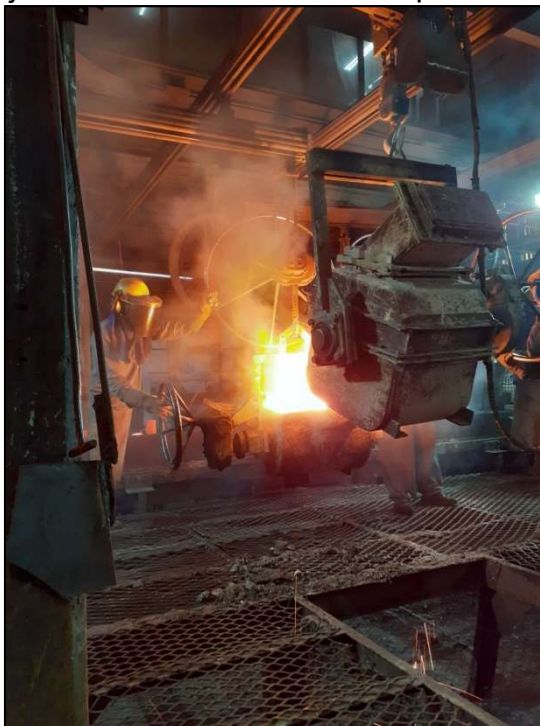
Figura 43 – Trajeto da talha até a Disa com panela de nodularização
