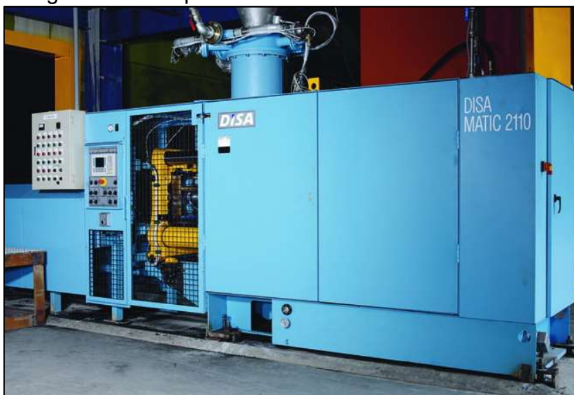
Figura 25 – Máquina de moldar: Disa Matic 2110 MK3
