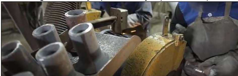
Figura 27 – Peças pós rebarbação (acabamento)
