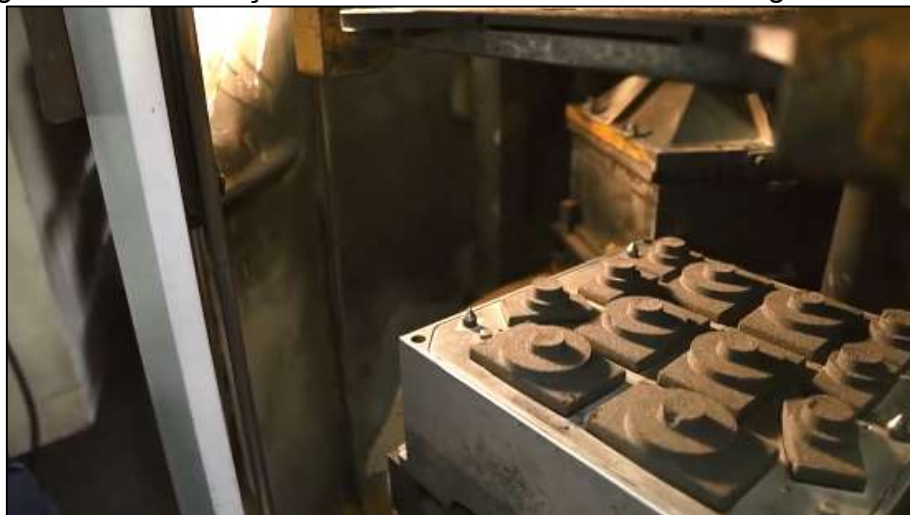
Figura 24 – Fabricação de machos no sistema de moldagem cold box
