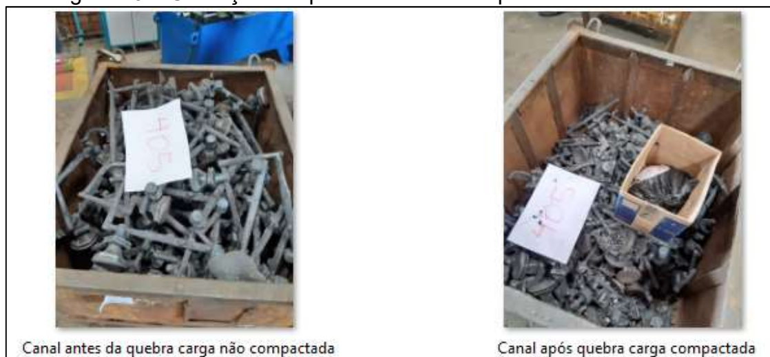
Figura 40 – Utilização do quebrador de canal para material de retorno
