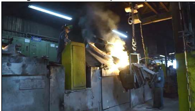
Figura 32 – Carregamento do metal líquido na panela de nodularização
