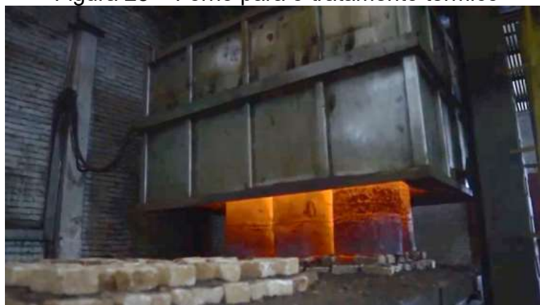
Figura 28 – Forno para o tratamento térmico
