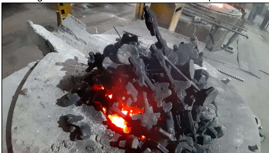
Figura 38 – Material de retorno não compactado
