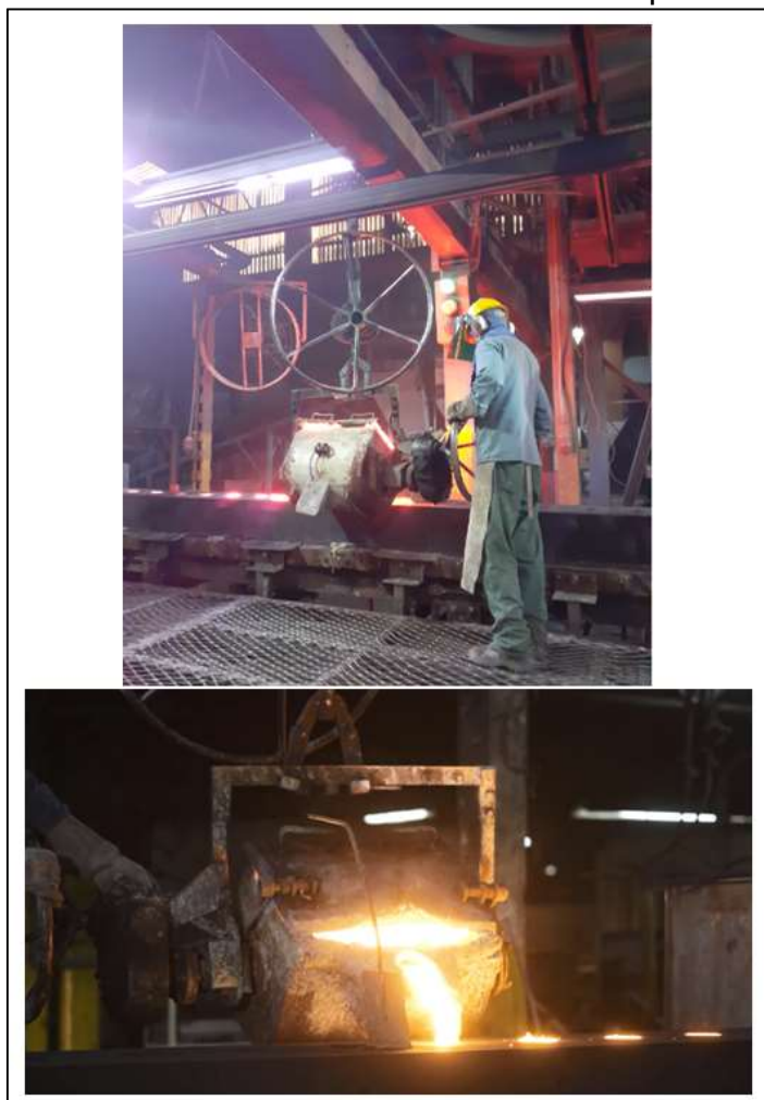
Figura 34 – Processo de vazamento do metal líquido no molde
