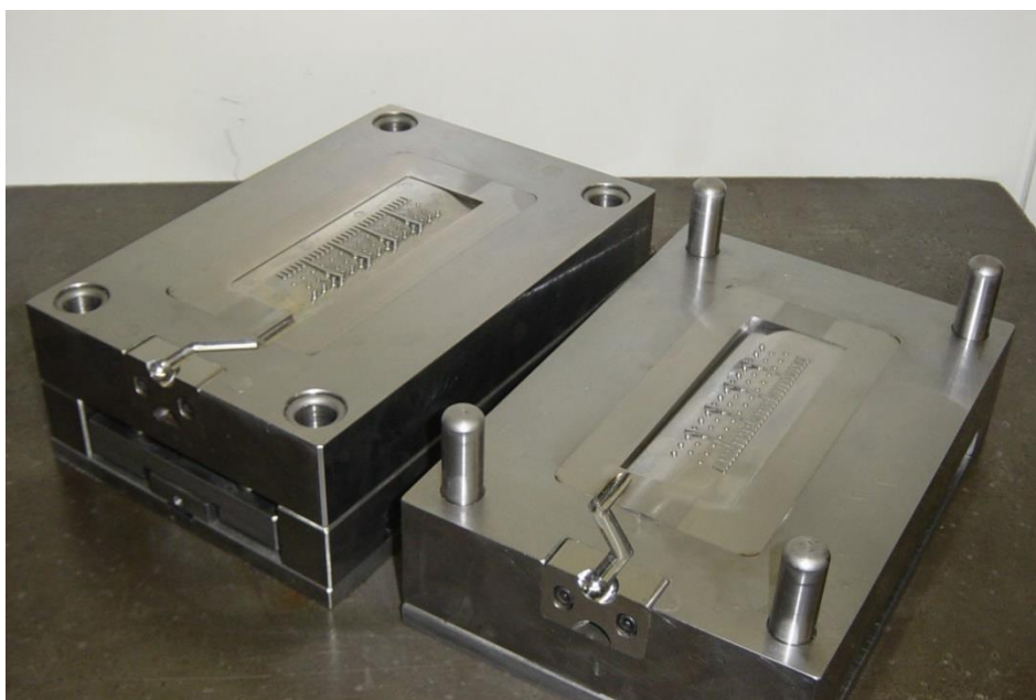
Figura 4 - Molde para injeção de cera para processo de microfundição
