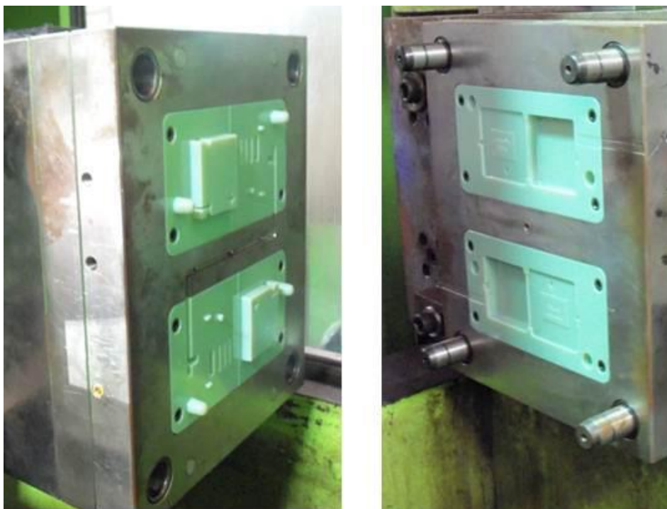
Figura 5 - Molde Híbrido para injeção plástica.
