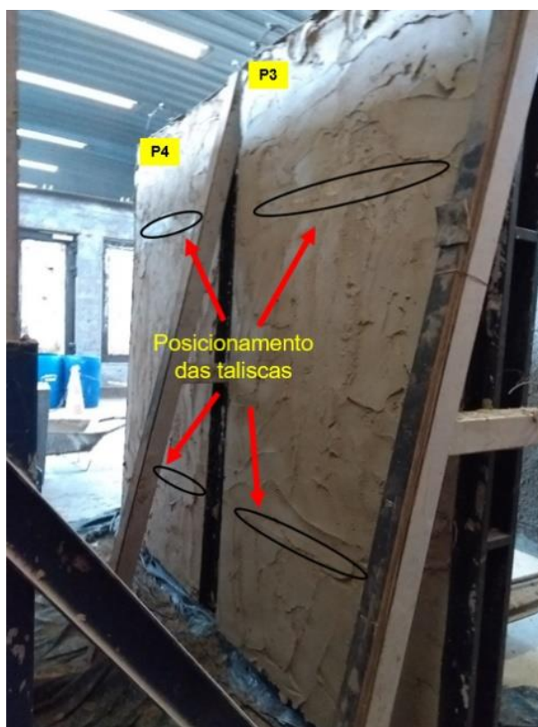
Figura 42 – Posição das taliscas das amostras P3 e P4 (face exposta ao ensaio)
