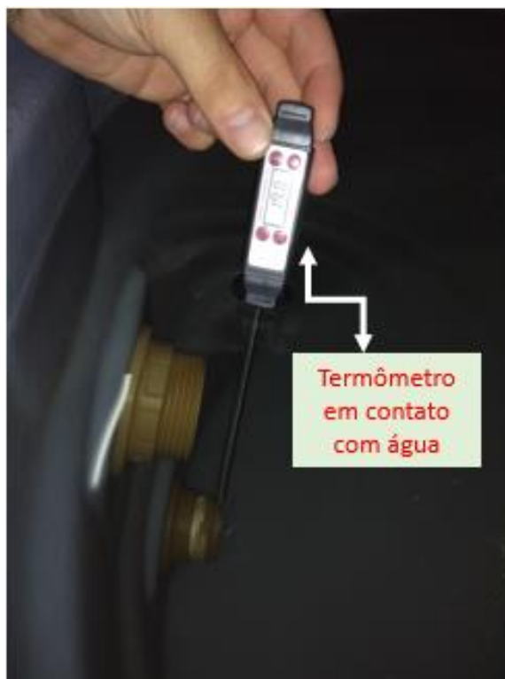
Figura 17 – Medição da temperatura da água de resfriamento
