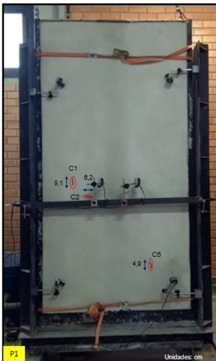
Figura 32 – Mapeamento das fissuras na amostra P1 (face oposta ao ensaio)
