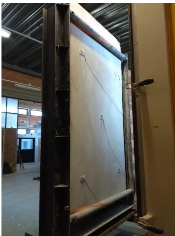
Figura 20 – Disposição dos termopares na face ensaiada
