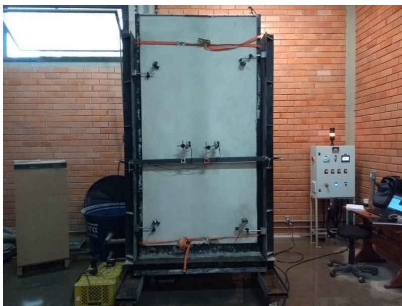
Figura 26 – Vazamento de água no resfriamento da amostra 1 (P1)
