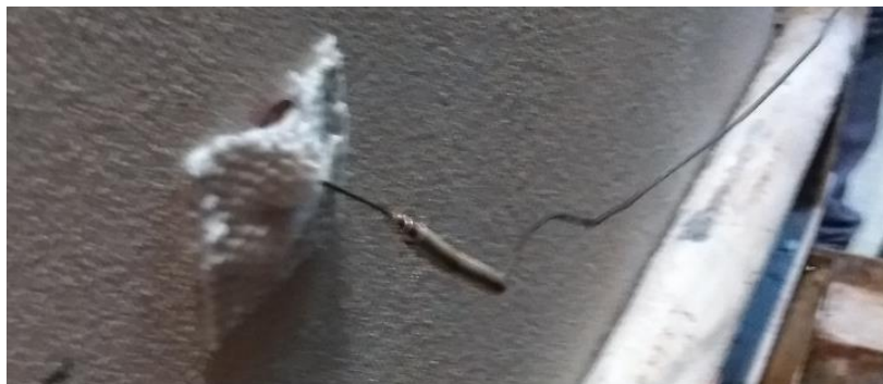
Figura 19 – Termopares tipo K com diâmetro de 1,5mm
