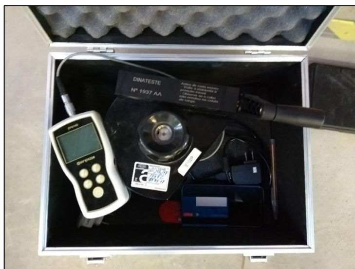
Figura 24 – Modelo dinamômetro de tração utilizado
