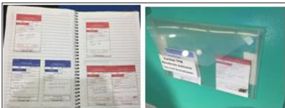
Figura 44 – Cartões de Manutenção Autônoma
