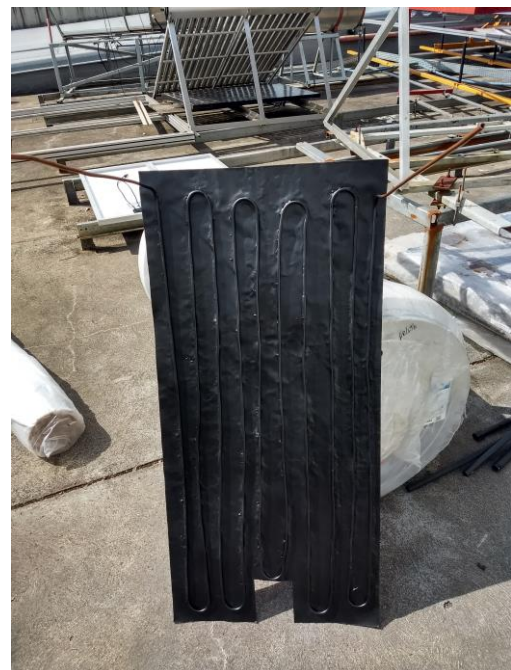
Figura 11 – Camada absorvedora montada contendo a chapa e o tubo de cobre.
