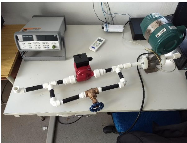
Figura 10 – Detalhe da conexão entre bomba e medidor de vazão e o sistema by-pass para o controle de vazão.
