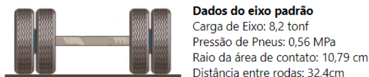
Figura 34 - Eixo padrão utilizado pelo MeDiNa
