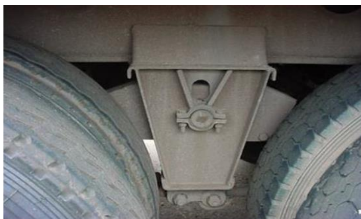
Figura 10 - Detalhe de uma suspensão em tandem
