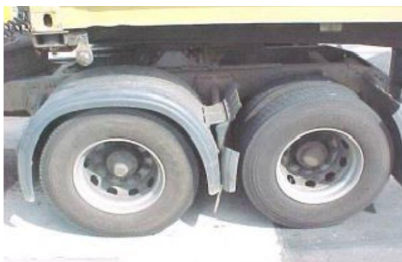
Figura 11 - Detalhe de uma suspensão em não tandem
