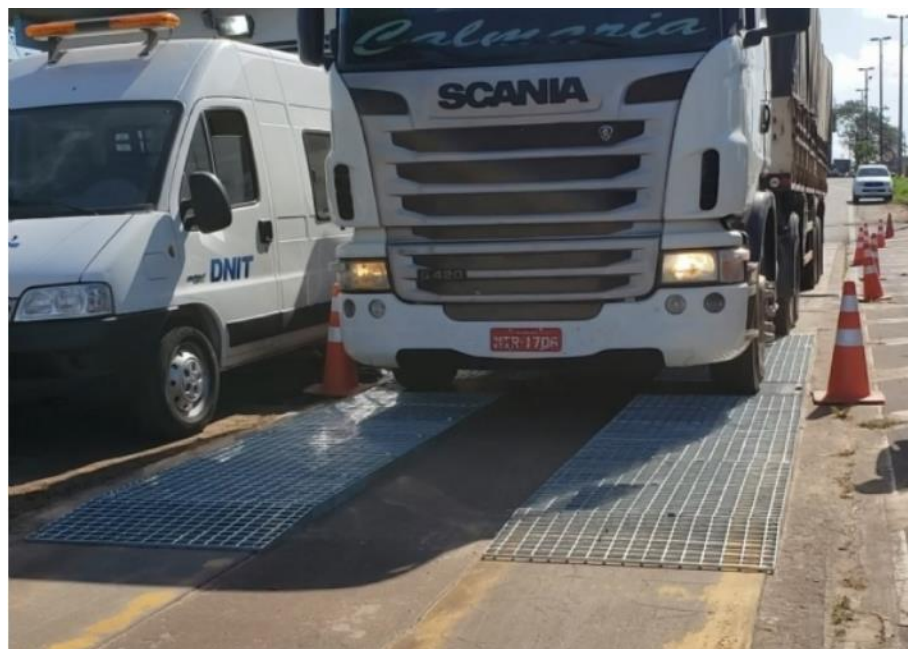
Figura 22 - Balança dinâmica e móvel em São Luís-MA, BR-135 km 14
