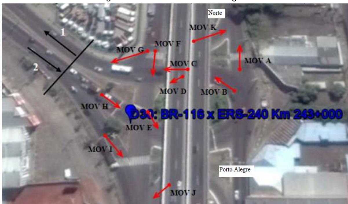
Figura 72 – Movimentos de tráfego no viaduto
