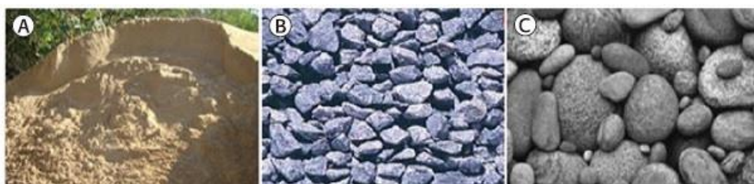
Figura 9 - Elementos Granulares do Solo a) areia, b) brita e c) seixo.
