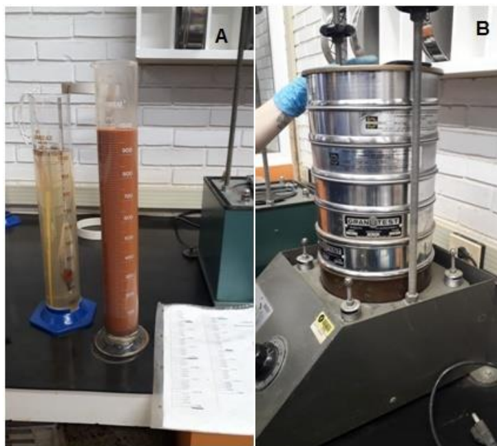
Figura 16 - Processos de sedimentação e peneiramento.
