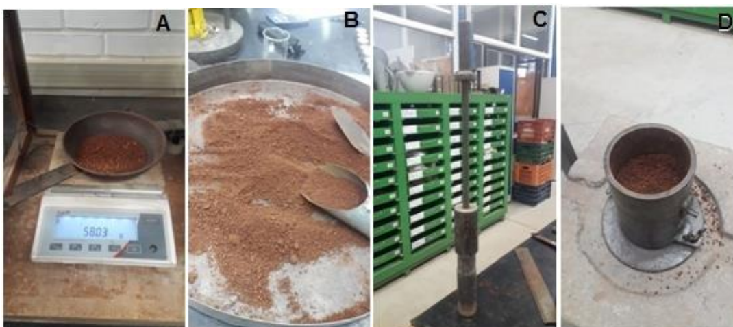
Figura 20 - Etapas do Ensaio de Próctor
