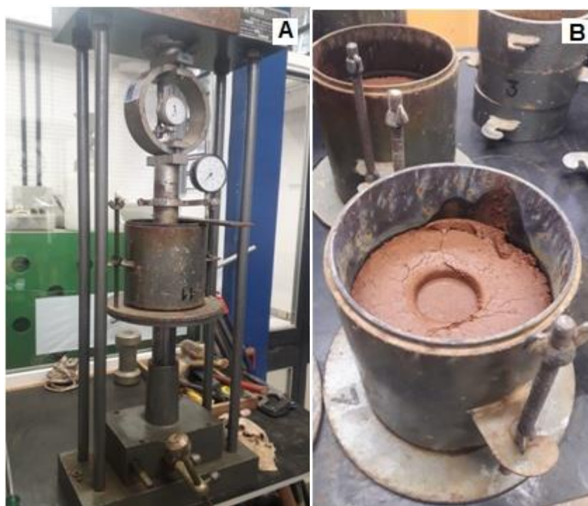
Figura 21 - Processo de rompimento dos CBR's.
