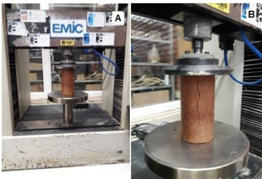
Figuras 22 - Processo de rompimento dos CBR's
