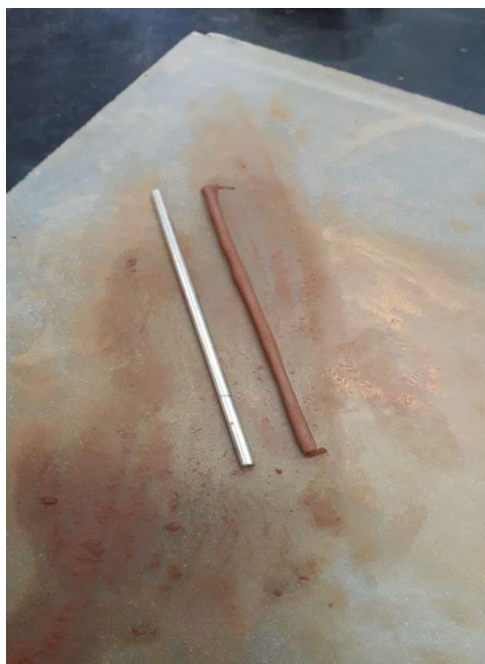
Figura 18 - Determinação do limite de plasticidade.
