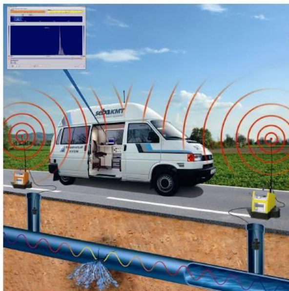
Figura 7 - Correlacionador de ruídos utilizando notebook e 2 sensores com transmissão dos dados via rádio frequência.
