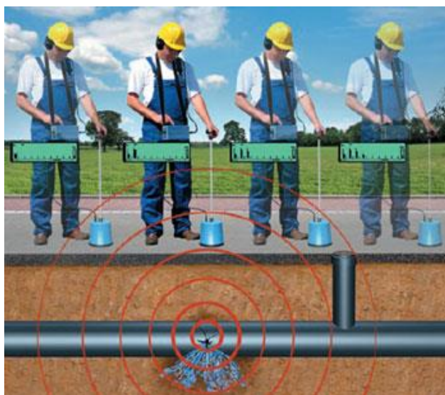
Figura 6 - Detecção de vazamento utilizando geofone eletrônico
