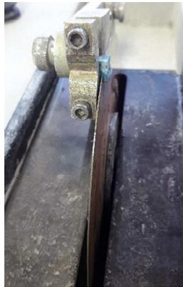
b) Amostra sendo cortada em serra de precisão
