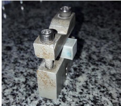
a) Fixação da amostra em adaptador para corte
