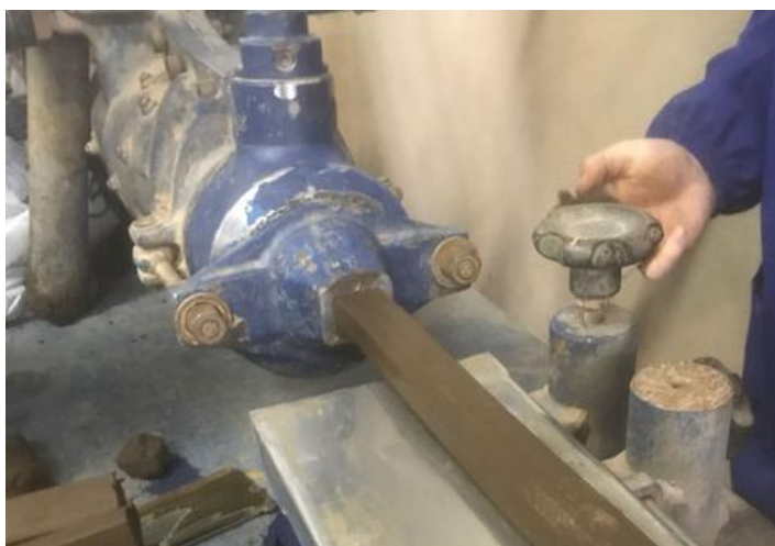
Figura 25 - Extrusão dos corpos de prova
