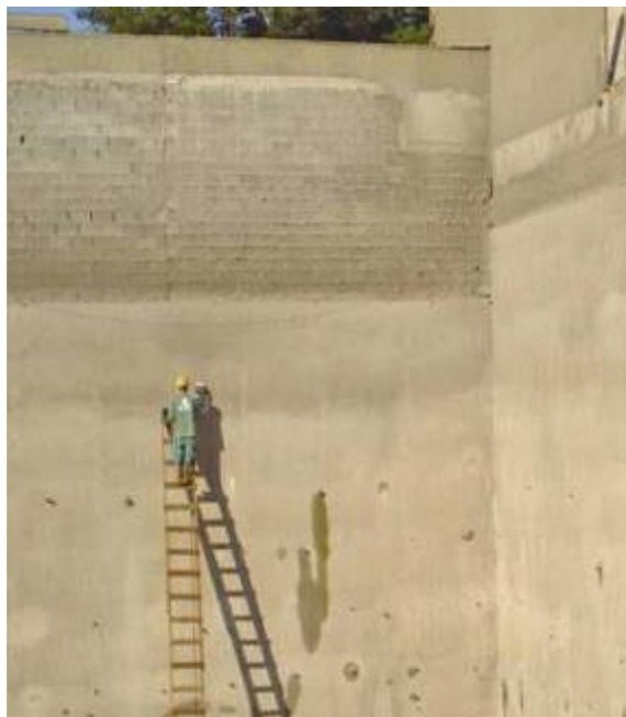
Figura 19 - Leitura de deformação horizontal
