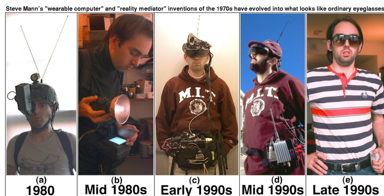
Figura 4 – A miniaturização progressiva da indústria de computadores permitiu que dispositivos vestíveis se tornassem menos intrusivos nos últimos anos
