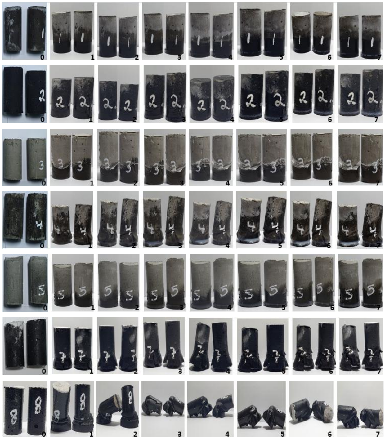
Figura E.1- Análise visual de eflorescência durante todas as idades
