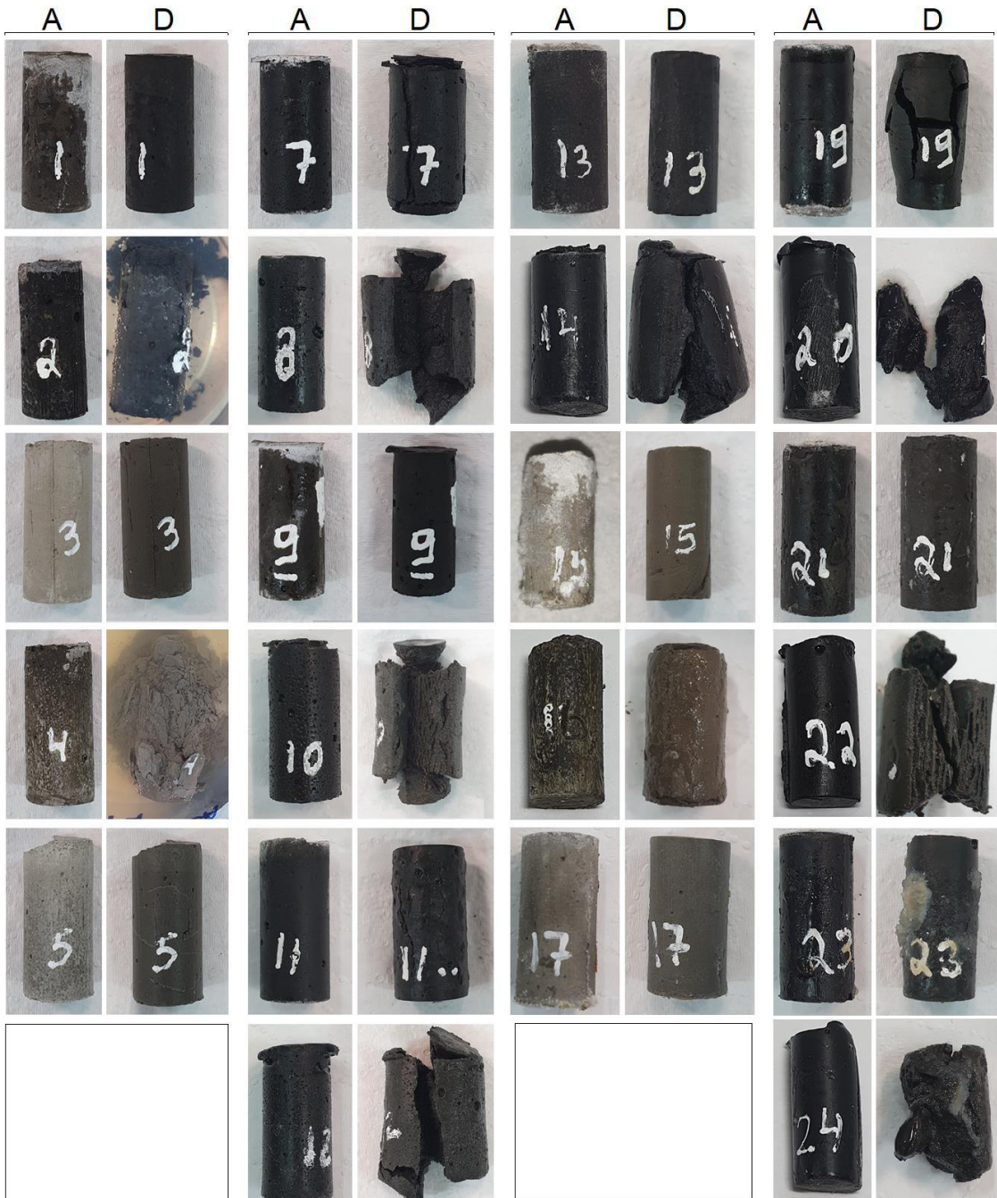
Figura 59 – Amostras ativadas por álcalis envelhecidas por 28 dias, antes (A) e depois (D) de ficarem 24h imersas em água.
