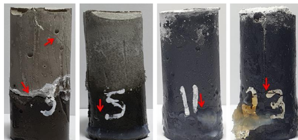
Figura 63 – Fissuras identificadas nos corpos de prova durante a análise de eflorescência.
