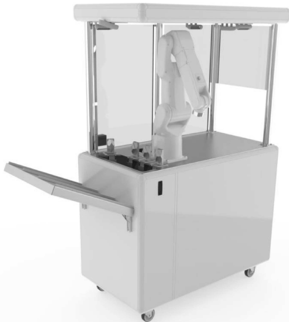
Figura 10: Flippy, assistente de cozinha robótico autônomo que utiliza um braço mecânico de seis eixos. (Fonte: Folha, 2018)
