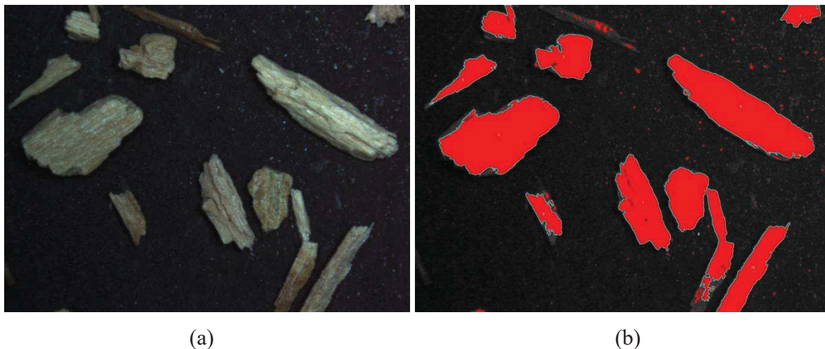
Figura 5.2 - Imagem de partículas de ramos de macieira com aumento de 62x (a) e selecionadas no software ImageJ (b)
