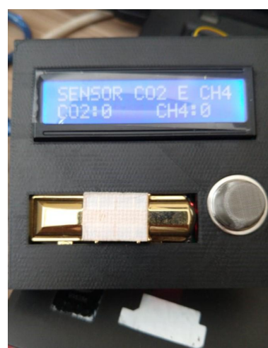
(b) Sensor de análise de gases desenvolvido, o sensor possibilita a análise de dióxido de carbono e metano para utilização em ambientes internos
