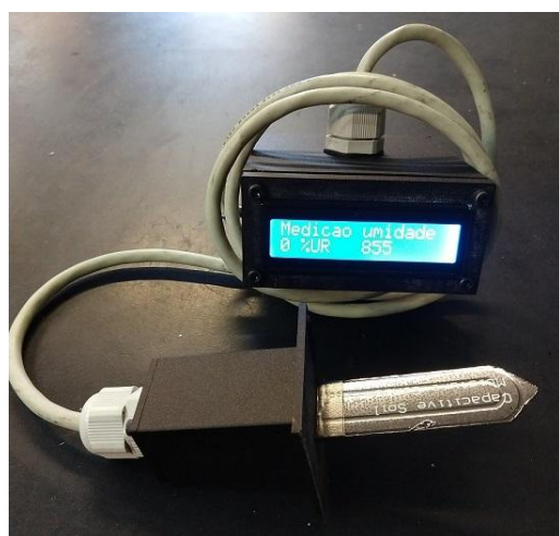
(a) Sensor de umidade do solo desenvolvido, o sensor possibilita a realização de medições da umidade em poucos segundos, o sensor funciona com uma bateria que pode ser recarregada com uma fonte de baixo consumo de energia elétrica
