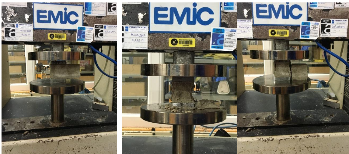
Figura 22 - Ensaio de resistência à compressão, corpos de prova antes, durante e após o ensaio.
