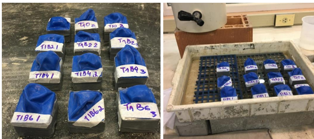
Figura 24 - Ensaio de absorção por capilaridade
