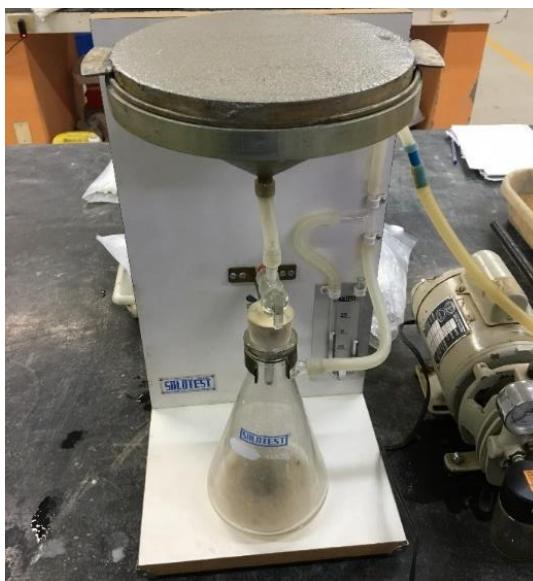
Figura 17 - Ensaio de retenção de água. Procedimento de sucção por bomba de vácuo.
