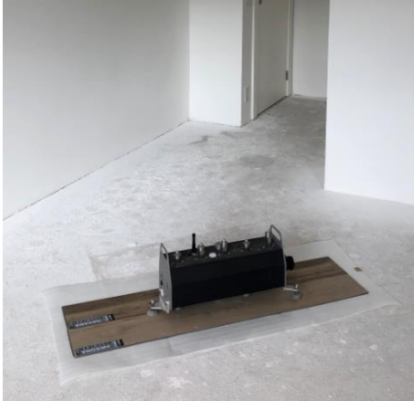
Figura 6 – Ensaio ruído de impacto no piso vinílico
