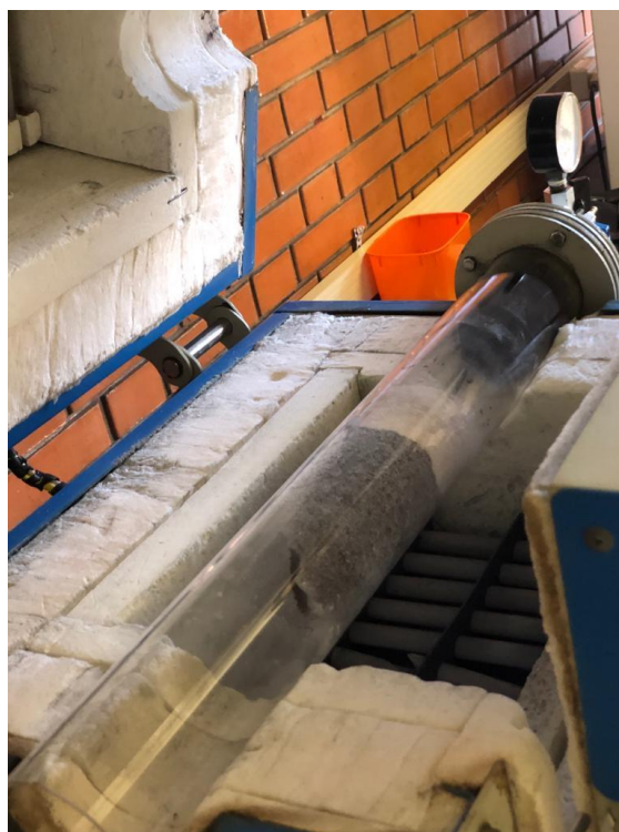
Figura 25 – Vista afastada: biomassa dentro do reator.
